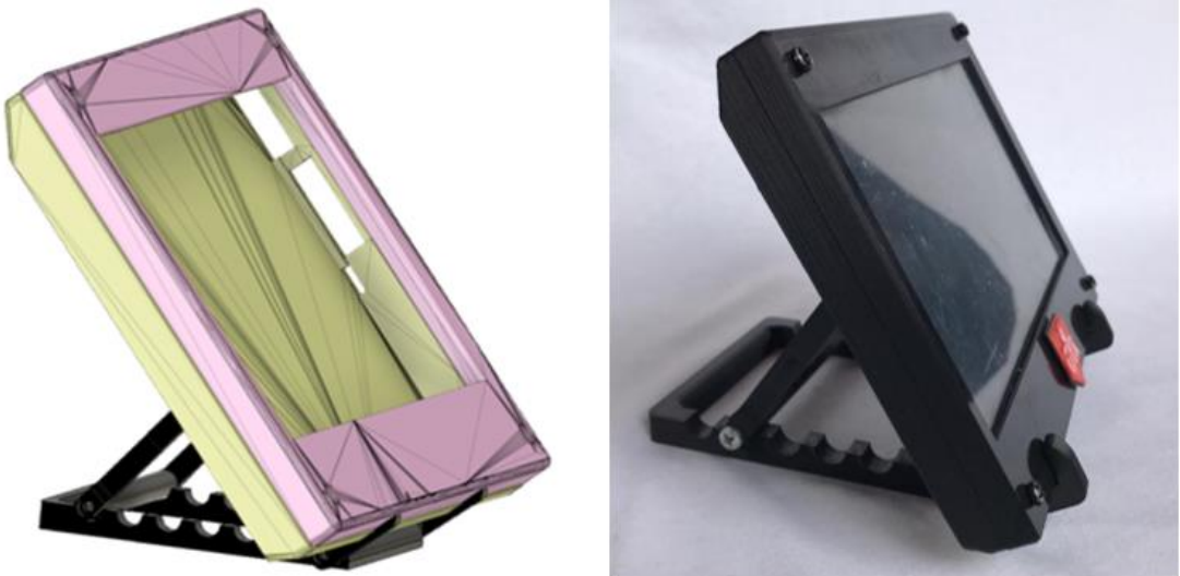
Figura 19. Comparativa de diseño simulado e implementado vista lateral
