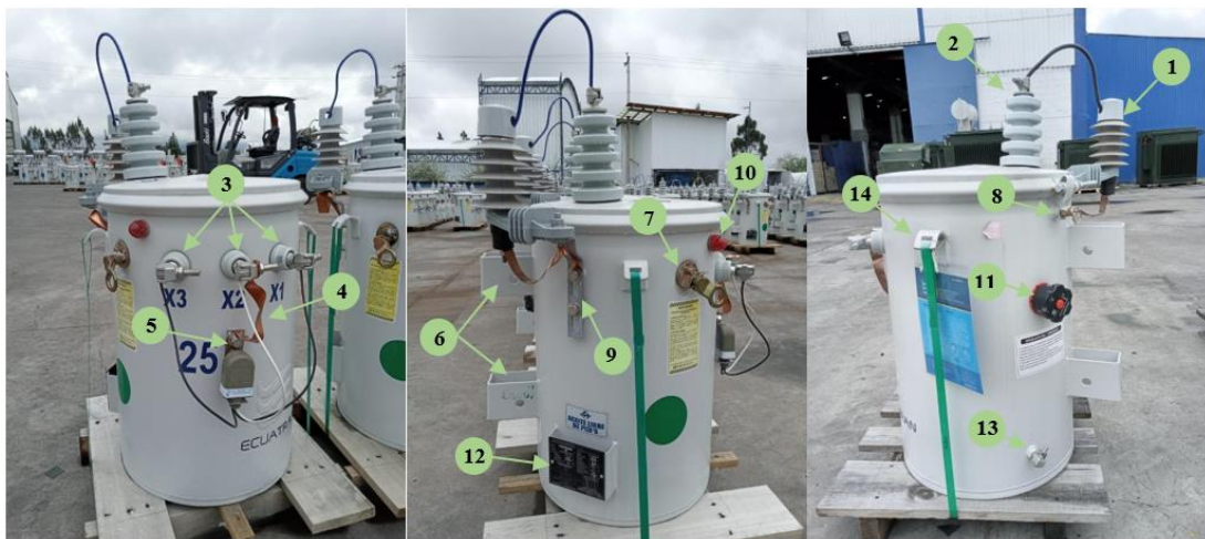
Figura 21. Componentes del transformador monofásico de 25 kVA.
