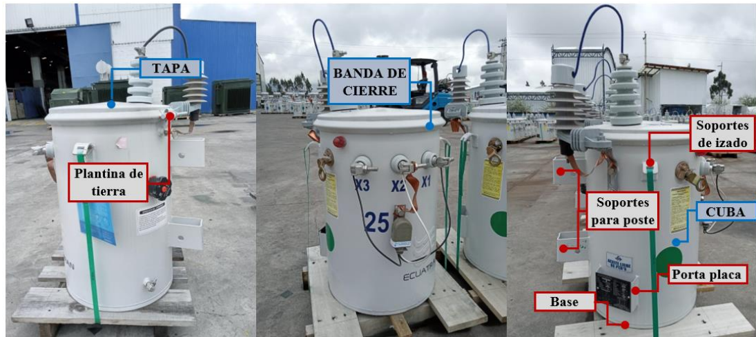
Figura 22. Partes principales fabricados en el área de metal mecánica.
