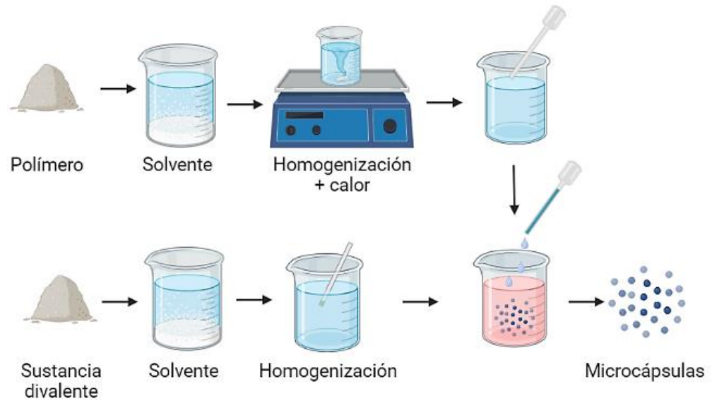
Figura 6. Proceso de microencapsulación por gelificación iónica
