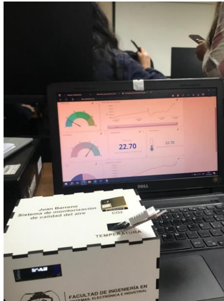
Figura 76. Pruebas de monitoreo en el laboratorio industrial 2
