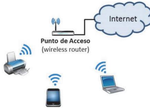
Figura 4. Esquema de una WLAN en el hogar [19]
