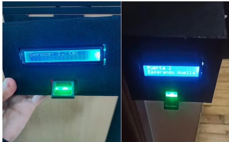
**Figura 88.** Activación del sistema de control de acceso
