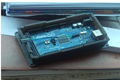
**Figura 67.** Colocación de la placa Arduino en el case diseñado
