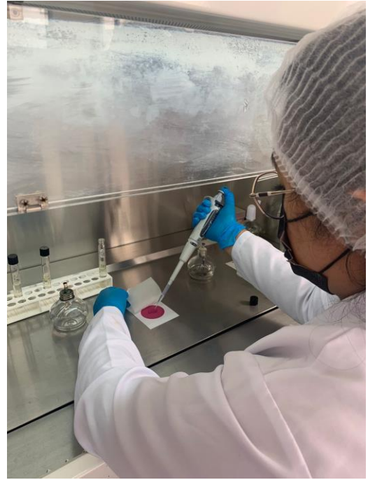
Anexo 9. Siembra de 1 ml de la muestra en placas petrifilm de Escherichia coli .
