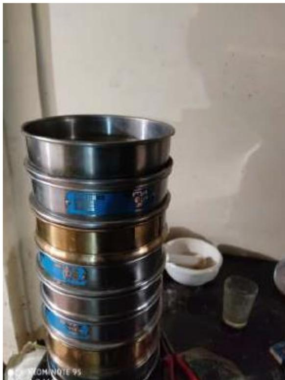
Fotografía 5. Tamices para ensayo granulométrico
