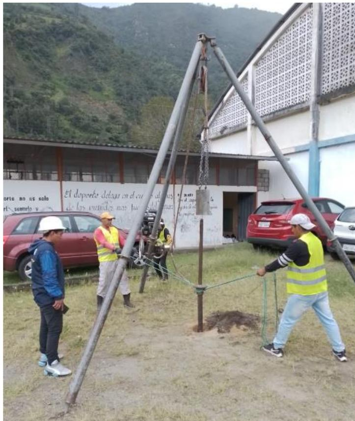
Fotografía 3. Ensayo de penetración estándar (SPT) en la zona de estudio.
