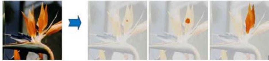
Figura 12: Ejemplo de segmentación orientada a regiones
