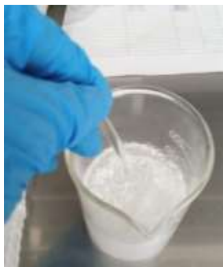
Anexo A. 2. Dilución del polímero Eudragit® en agua destilada con NaOH
