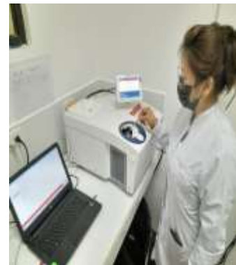
Anexo E. 3. Colocación de crisol con muestra en DSC
