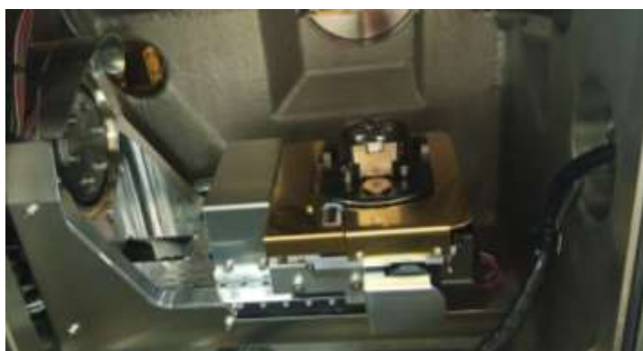
Anexo F. 2. Colocación de las muestras en el microscopio electrónico de barrido
