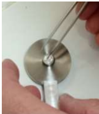
Anexo E. 2. Colocación del crisol en placa de orificio compactadora
