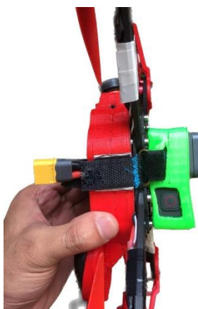
Figura 77. Soporte adaptado al UAV. Elaborado por: Los investigadores.
