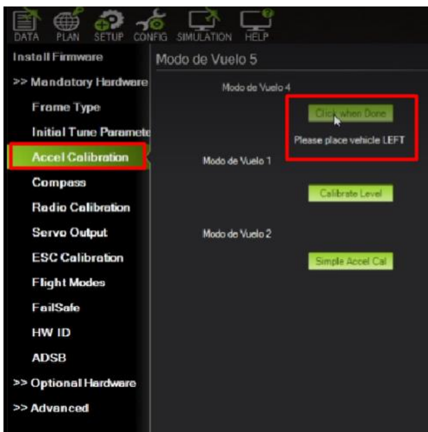
Figura 42. Calibración del acelerómetro. Elaborado por: Los investigadores.
