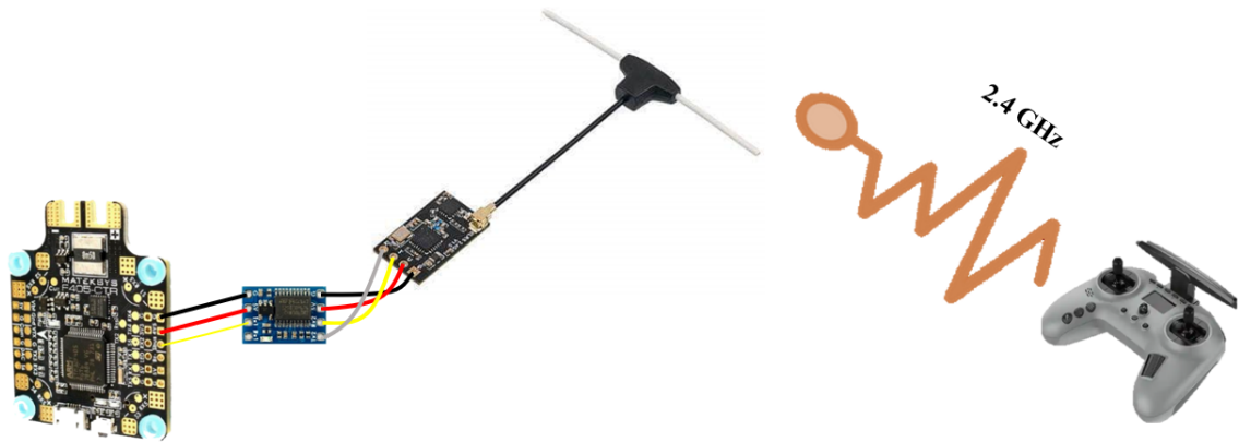
Figura 38. Conexiones del sistema de radio control. Elaborado por: Los investigadores.
