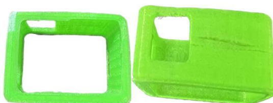
Figura 76. Soporte personalizado para la cámara GoPro Hero 5 Black. Elaborado por: Los investigadores
