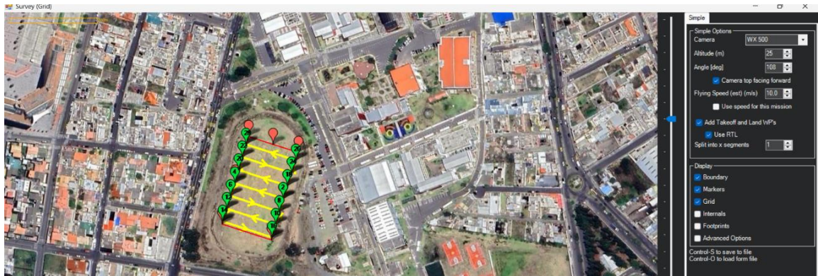
Figura 72. Parámetros de la cámara para generar rutas para misión de vuelo. Elaborado por: Los investigadores.
