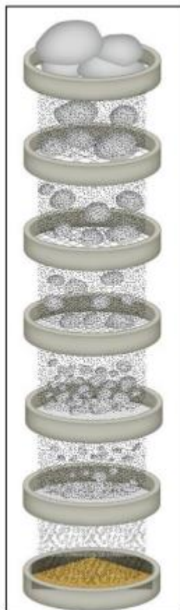
Figura 6. Ensayo de granulometría con tamices
