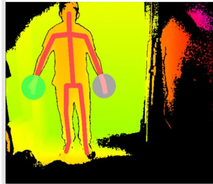
**Figura 12.** Detección del esqueleto humano en 2D mediante Kinect Studio
