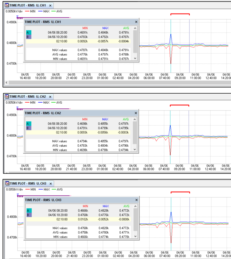
Figura 33 Detalle de curvas de voltaje.
