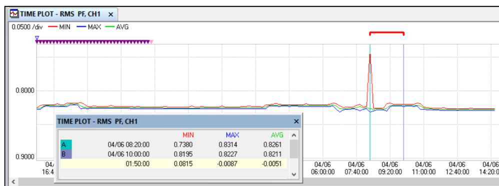
Figura 35 Detalle de curvas del factor de potencia.
