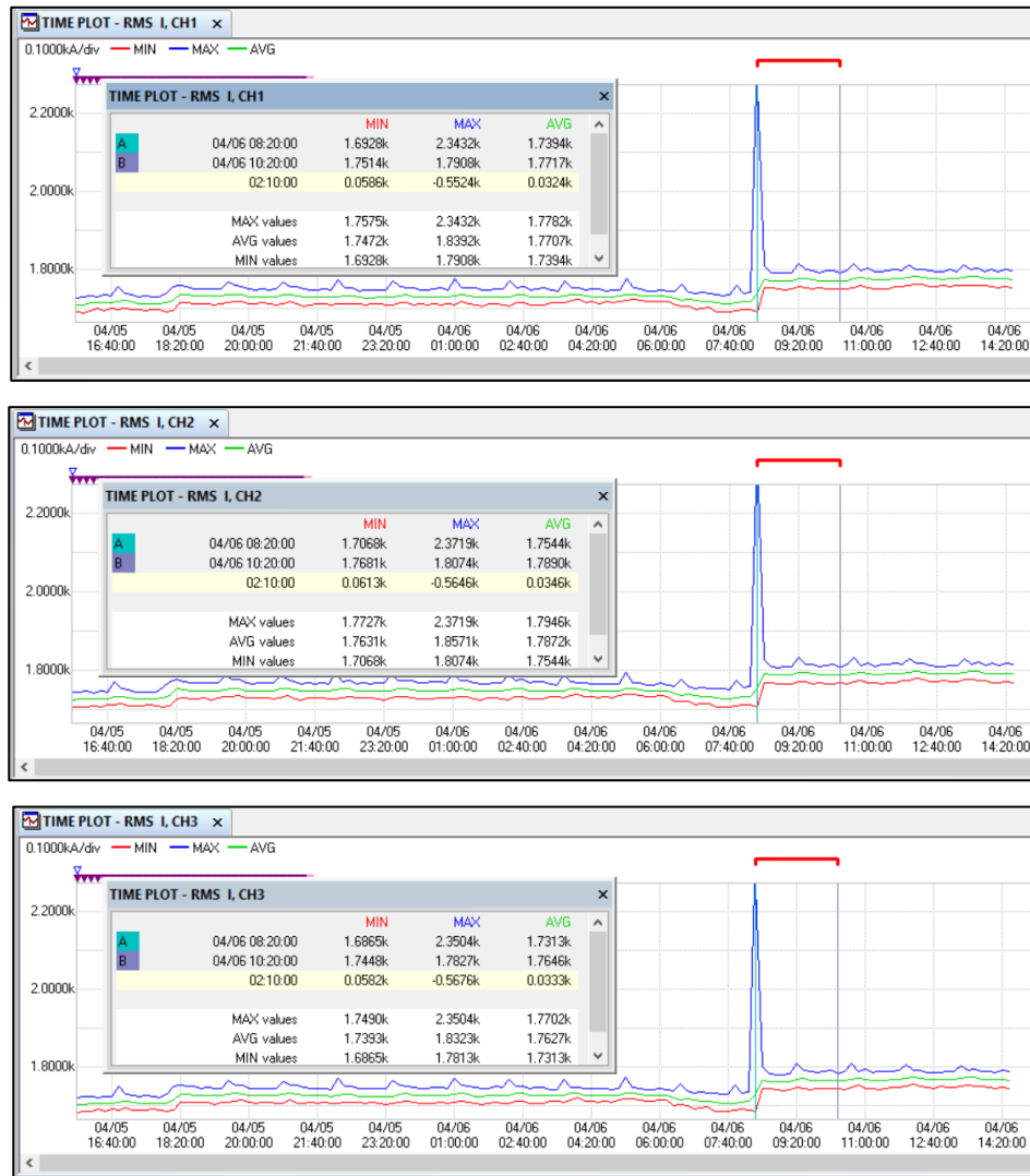
Figura 31 Detalle de curva de corriente por fase.
