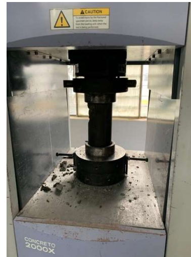
Ensayo a compresión de cilindros
