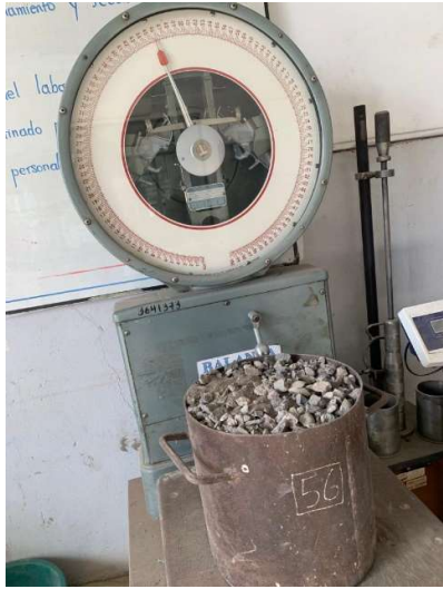
Peso de cilindro + agregado combinado
