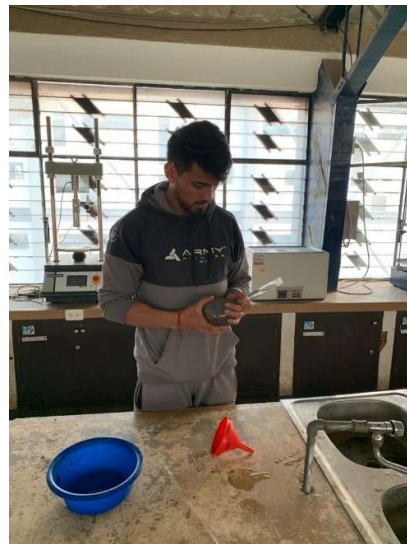
Girando picnómetro para eliminar Burbujas
