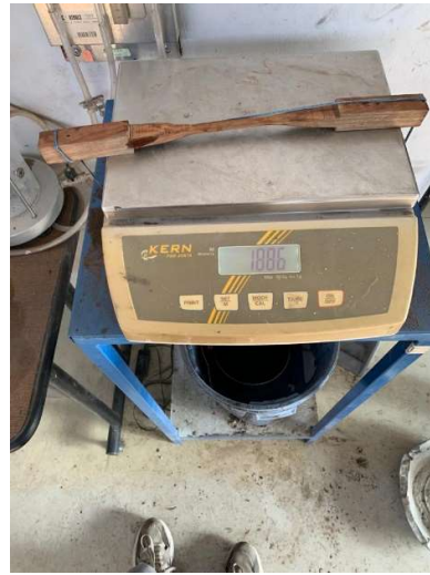
Peso de canastilla sumergida con agregado grueso
