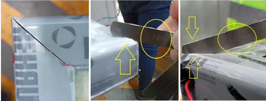
Figura 4-12: Aberturas en los vértices del marco.
