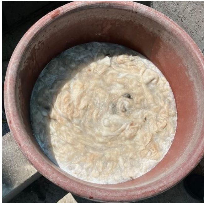
Figura 16. Prueba de lavado 1 solo con bicarbonato
