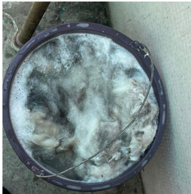
Figura 17. Prueba de lavado 2 bicarbonato y detergente
