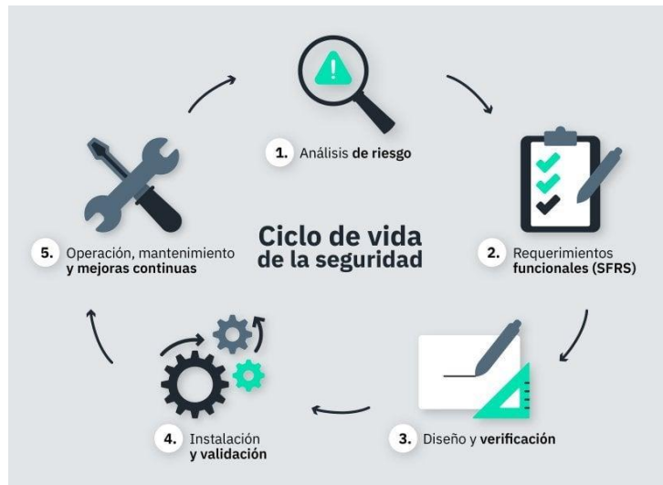
Figura 1. Ciclo de la seguridad industrial [29]
