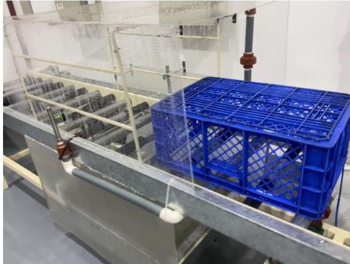
Figura 25. Gaveta en la zona de detección del sensor de proximidad
