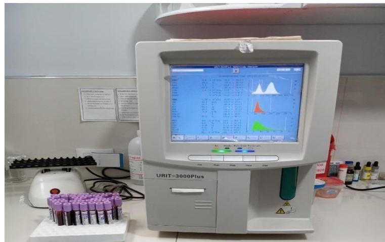
Fotografía 4: Equipo hematológico automatizado URIT 3000 Plus.
