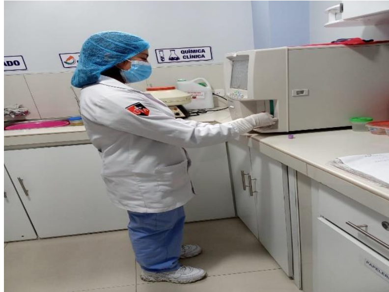
Fotografía 11: Ingreso de las muestras al contador hematológico automatizado.
