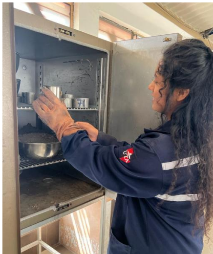
Fig 16. Ensayo contenido de humedad
