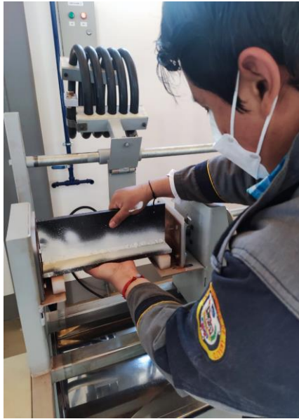
7. Realización de la inspección y evaluación de discontinuidades bajo luz UV
