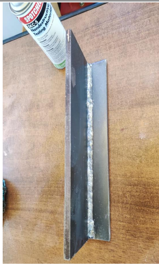
8. Limpieza posterior a inspección del elemento
