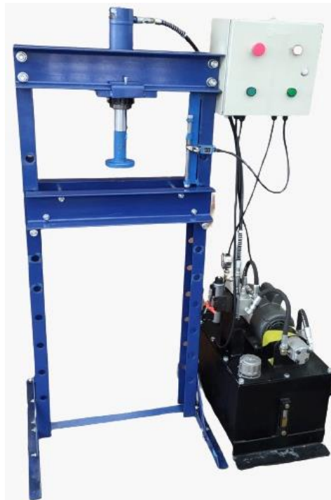
Figura 35: Rediseño de la prensa oleo – hidráulica
