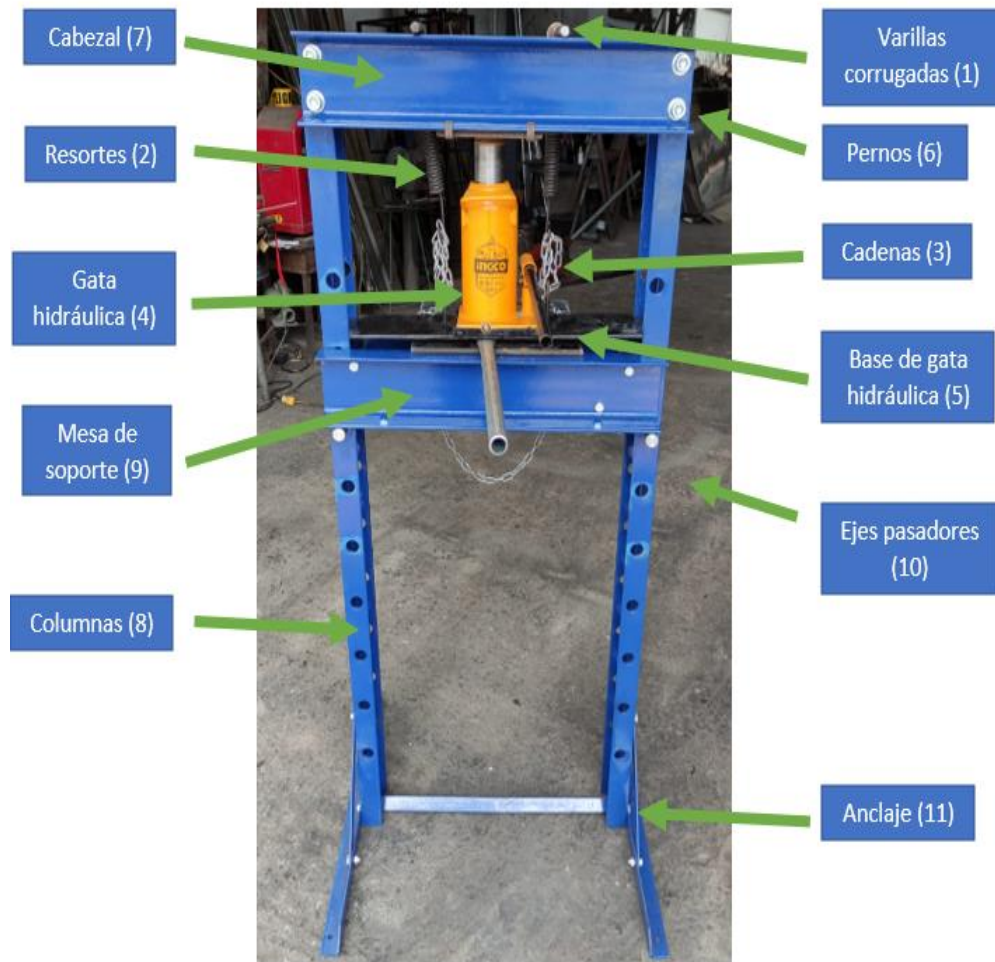
Figura 3: Prensa hidráulica inicial con gata hidráulica
