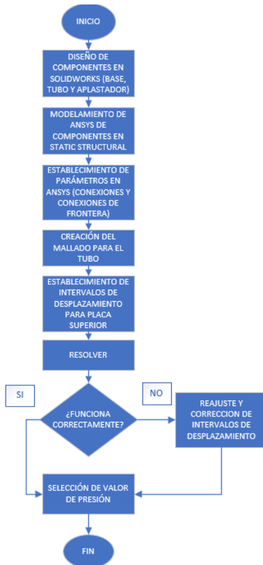
Figura 4: Proceso de obtención de presión necesaria para conformado
