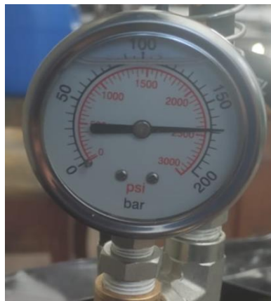
Figura 37: Presión existente en el sistema oleo – hidráulico
