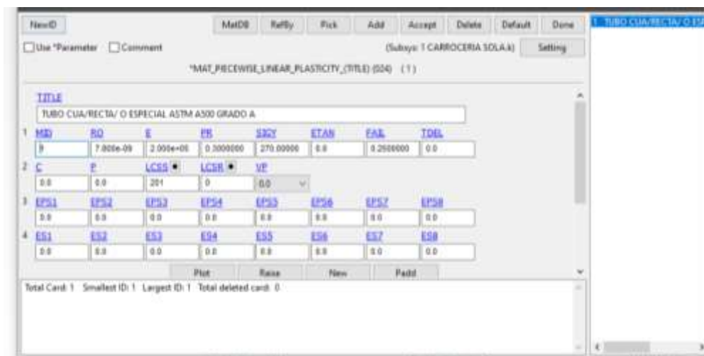
Figura 21: Asignación de valores del material ASTM A500 GRADO A.
