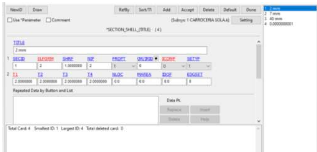
Figura 20: Asignación de espesores en los diferentes componentes de la superestructura del autobús.
