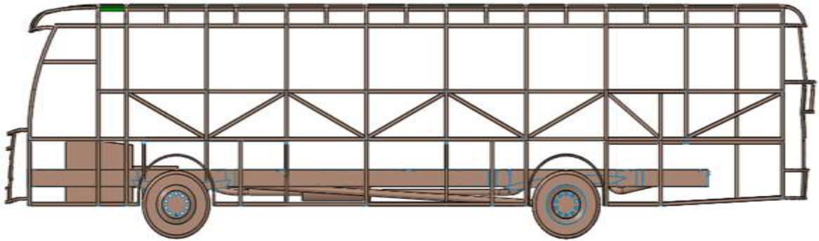
Figura 11: Vista lateral izquierdo de la superestructura.
