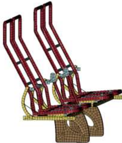
Figura 18: Aplicación de malla en la estructura de los asientos.
