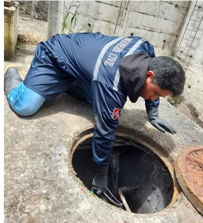
Figura 12. Medición del caudal de salida de la PTAR Andahualo.
