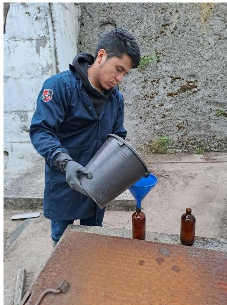
Figura 6. Recolección de muestras del efluente de la PTAR.
