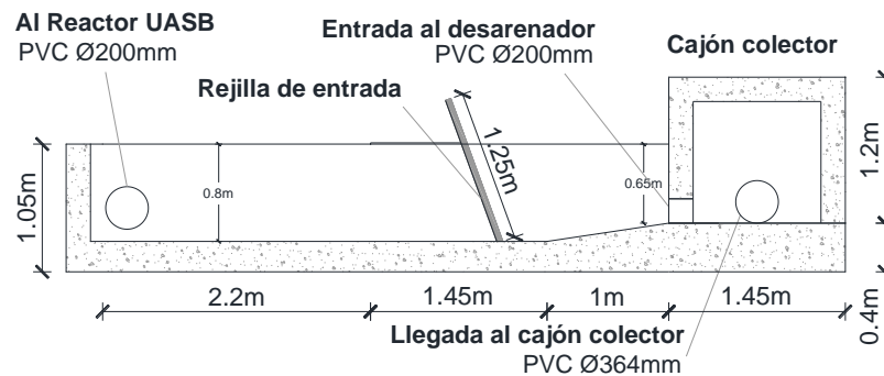
Figura 17. Vista en perfil del cajón recolector y desarenador.
