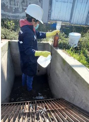
Fig. 25 Toma de muestra de agua residual al ingreso de la PTAR.
