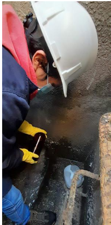
Fig. 26 Toma de la muestra de agua residual tratada a la salida de la PTAR
