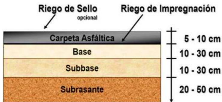
Gráfico 28: "Corte transversal (Pavimento flexible)."
