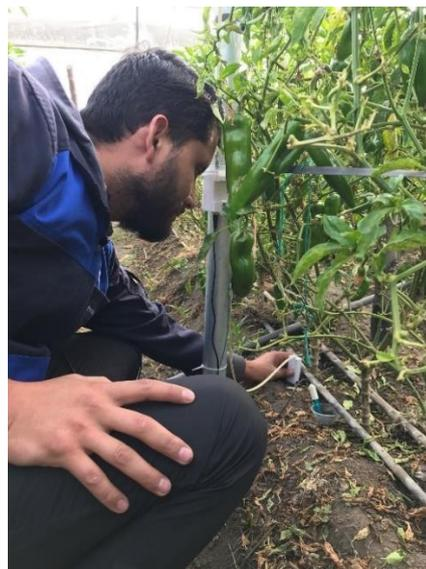
**Figura 131.** *Instalación del sensor de humedad del suelo*
