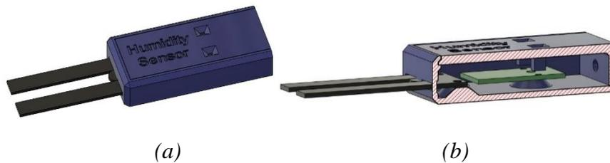
**Figura 111.** Carcasa para sensores de humedad del suelo. (a) Vista frontal y lateral; (b) Vista lateral del interior
