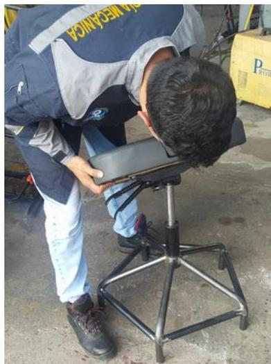
**Figura 42** Colocación de la base del asiento en el pistón.
