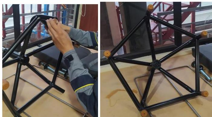
**Figura 47** Colocación de los regatones en el reposapiés.
