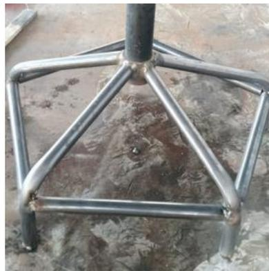
**Figura 29** Reposapiés metálico construido.
