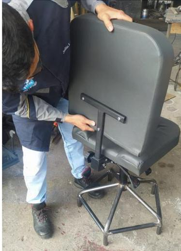
**Figura 43** Colocación del espaldar en la base del asiento.
