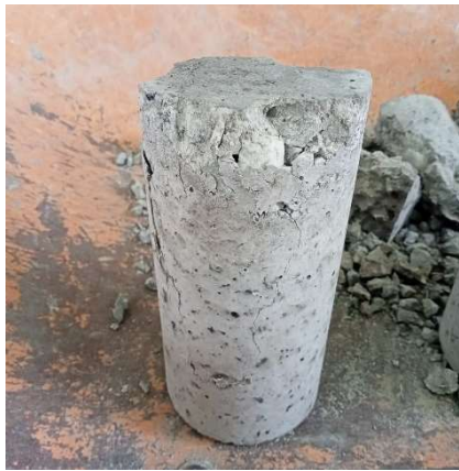
Fotografía 40: Esquema de falla del hormigón con fibras de caucho al 5 y 10%.
