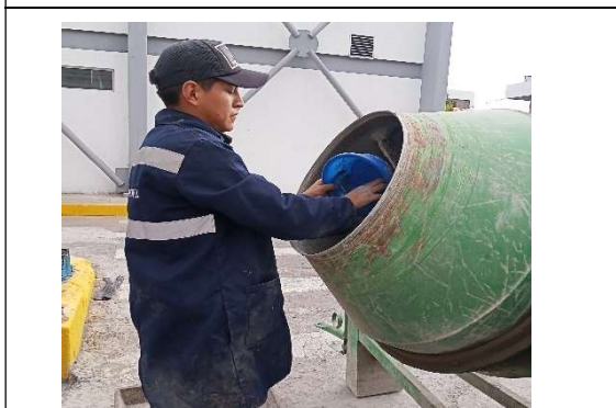
Fotografía 30: Introducción de los materiales en la concretera para la preparación de la mezcla del hormigón con fibras de caucho al 10%.
