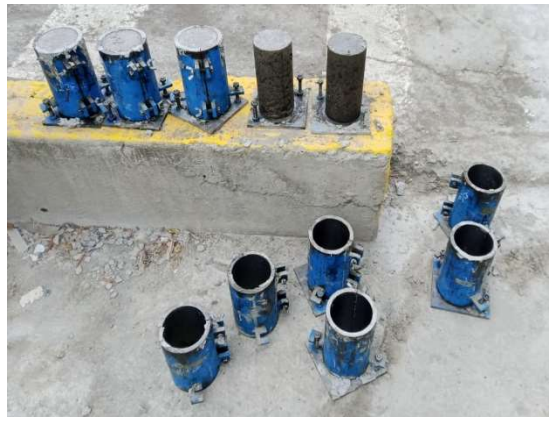
Fotografía 32: Registro de pesos del hormigón fresco y posterior desencofrado de los cilindros.
