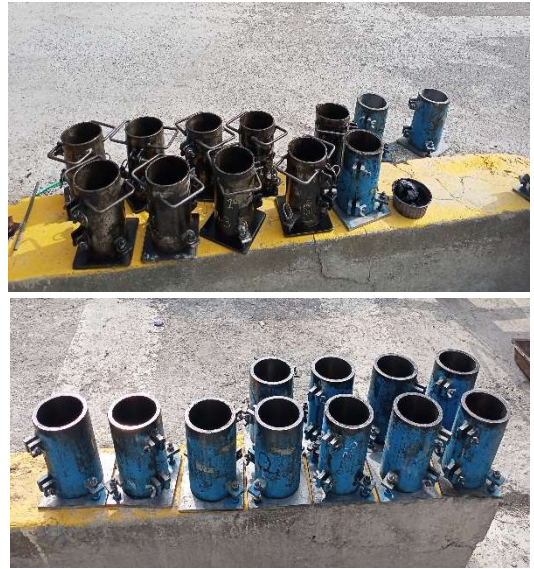
Fotografía 20: Preparación de los cilindros metálicos (limpieza y engrasado).
