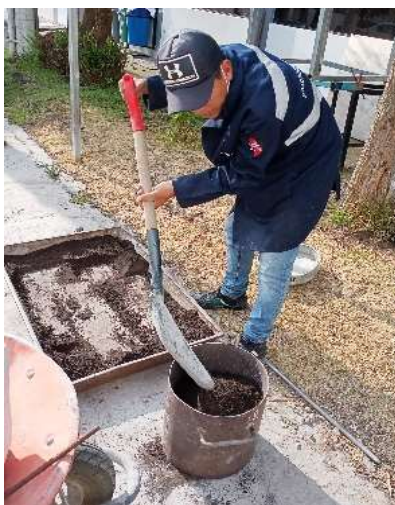
Fotografía 10: Densidad aparente compactada del agregado fino.
