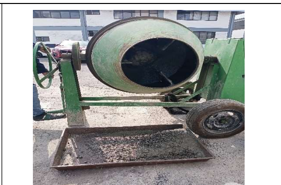
Fotografía 31: Obtención de la mezcla de hormigón con fibras de caucho al 10%.
