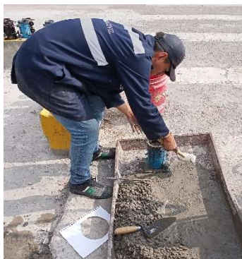
Fotografía 24: Toma de muestra de hormigón simple en cilindros.
