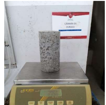
Fotografía 34: Retiro y secado de cilindros de la cámara de curado.
