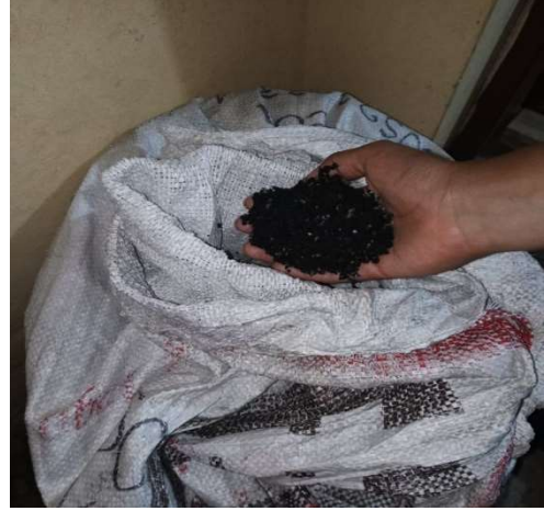
Fotografía 12: Fibras de caucho de neumáticos de 2mm a 4mm.
