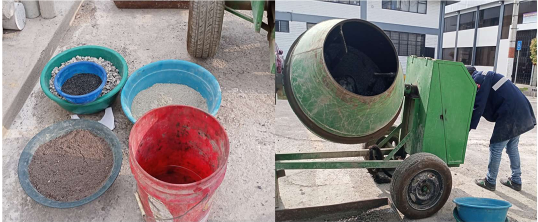
Fotografía 25: Preparación de equipos y materiales para la elaboración del hormigón con fibras de caucho al 5% (concretera, fuentes, bailejo, bandejas, varilla de compactación, martillo de goma, cantidades de los agregados, cemento, fibras de caucho y agua).
