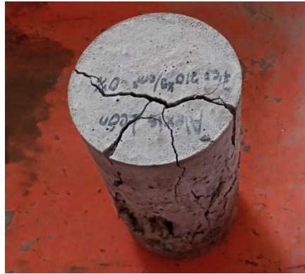
Fotografía 37: Esquema de falla del hormigón simple.
