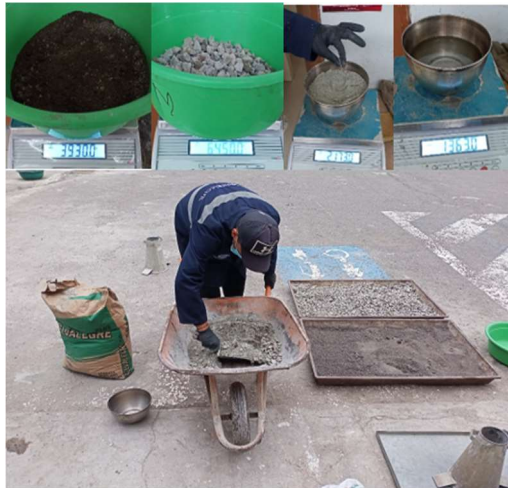
Fotografía 13: Primer ensayo de asentamiento con el Cono de Abrams (hormigón simple).
