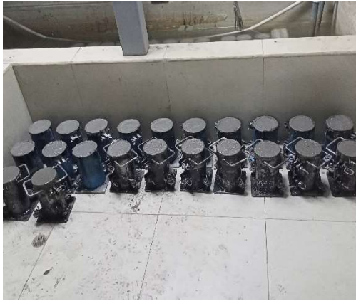
Fotografía 32: Registro de pesos del hormigón fresco y posterior desencofrado de los cilindros.
