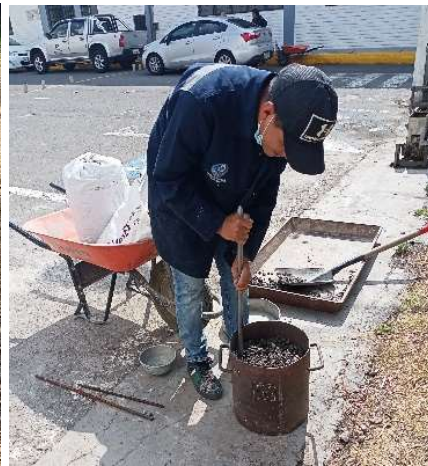
Fotografía 9: Densidad aparente compactada del agregado grueso.
