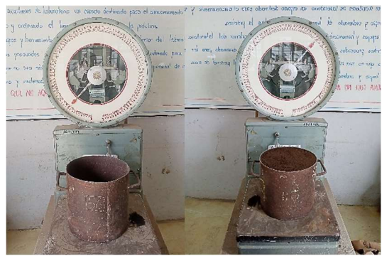
Fotografía 8: Densidad aparente suelta del agregado fino.
