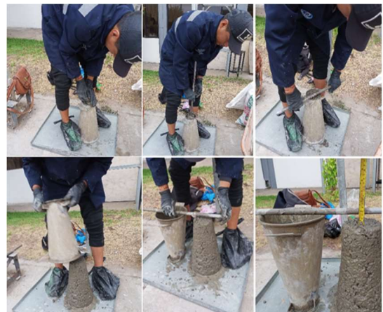
Fotografía 18: Medición del asentamiento del hormigón con fibras de caucho al 10%, con el Cono de Abrams (vertido de hormigón, levantamiento de molde, medición y registro del asentamiento).
