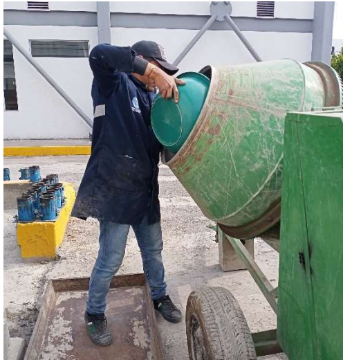
Fotografía 22: Introducción de los materiales en la concretara para la preparación de la mezcla del hormigón simple.
