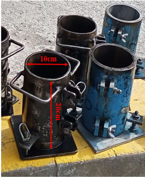
Fotografía 19: Cilindros metálicos de 10cm de diámetro por 20cm de alto.
