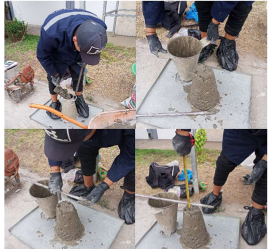
Fotografía 14: Medición del asentamiento del hormigón simple con el Cono de Abrams (vertido de hormigón, levantamiento de molde, medición y registro del asentamiento).
