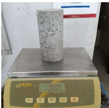
Fotografía 35: Peso de cilindros de hormigón seco.
