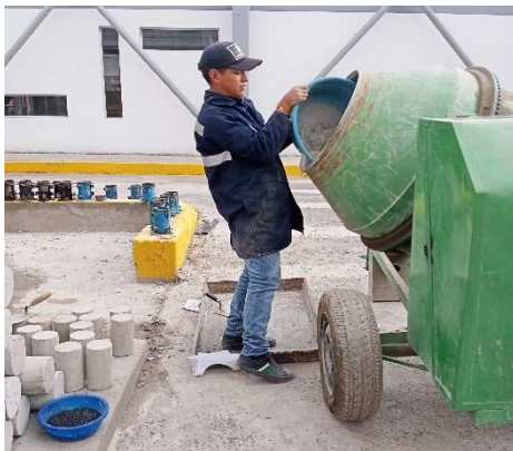
Fotografía 26: Introducción de los materiales en la concretera para la preparación de la mezcla del hormigón con fibras de caucho al 5%.
