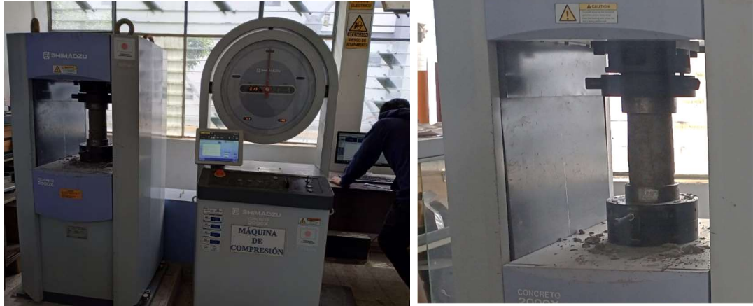
Fotografía 36: Ensayo a compresión del hormigón simple.
