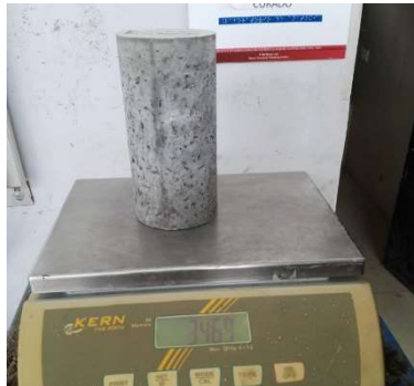
Fotografía 35: Peso de cilindros de hormigón seco.
