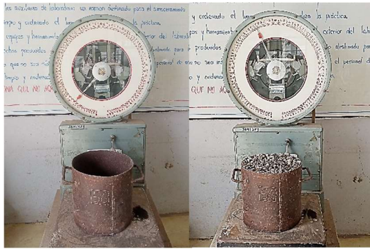
Fotografía 7: Densidad aparente suelta del agregado grueso.
