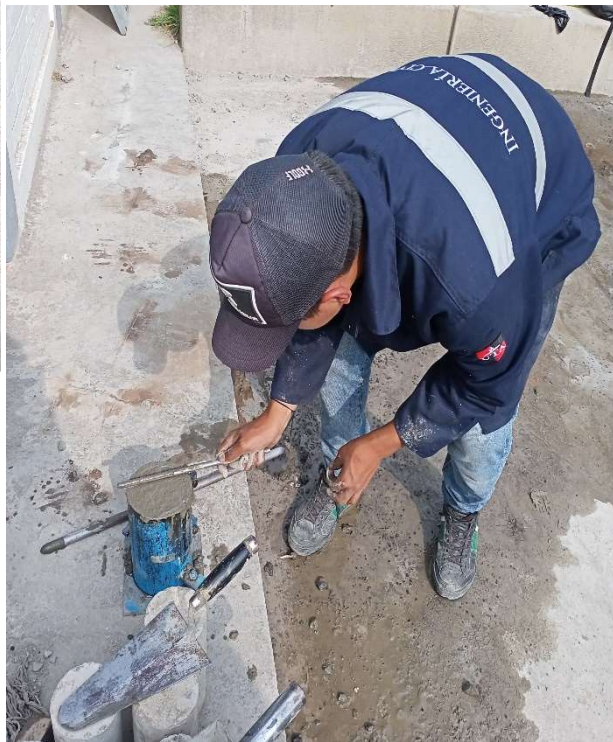
Fotografía 24: Toma de muestra de hormigón simple en cilindros.
