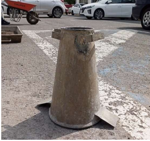
Fotografía 11: Cono de Abrams para ensayar.
