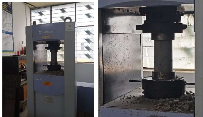
Fotografía 39: Ensayo a compresión del hormigón con fibras de caucho al 5 y 10%.
