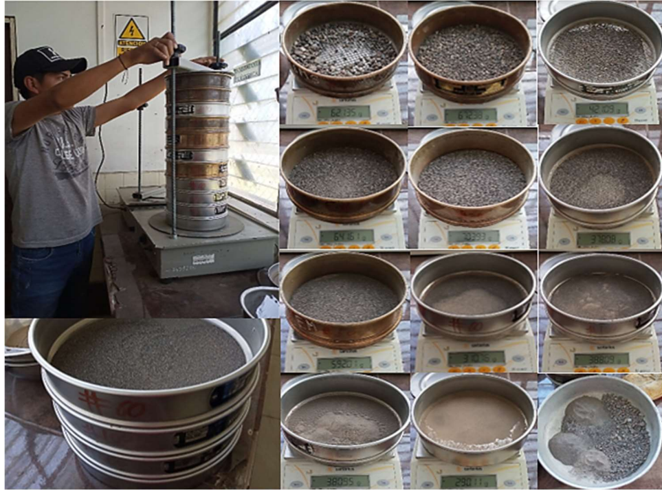
Fotografía 5: Granulometría del agregado fino (arena)
