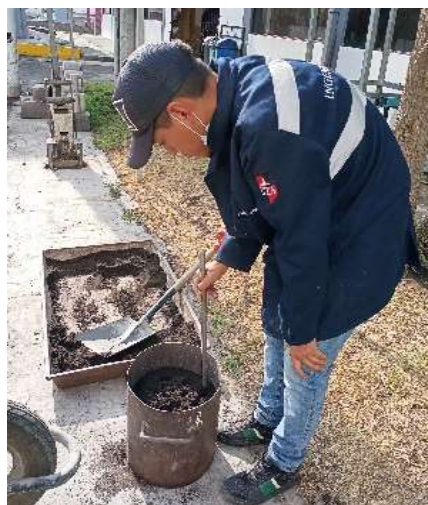
Fotografía 10: Densidad aparente compactada del agregado fino.
