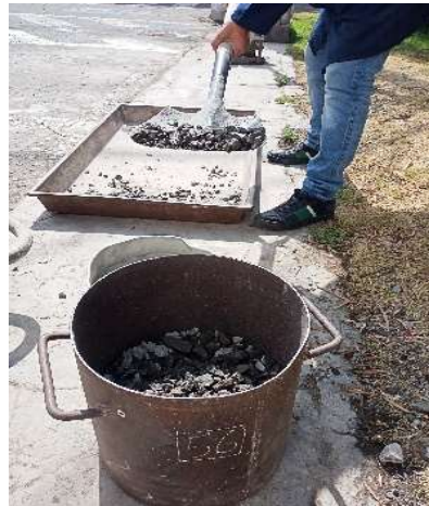
Fotografía 9: Densidad aparente compactada del agregado grueso.
