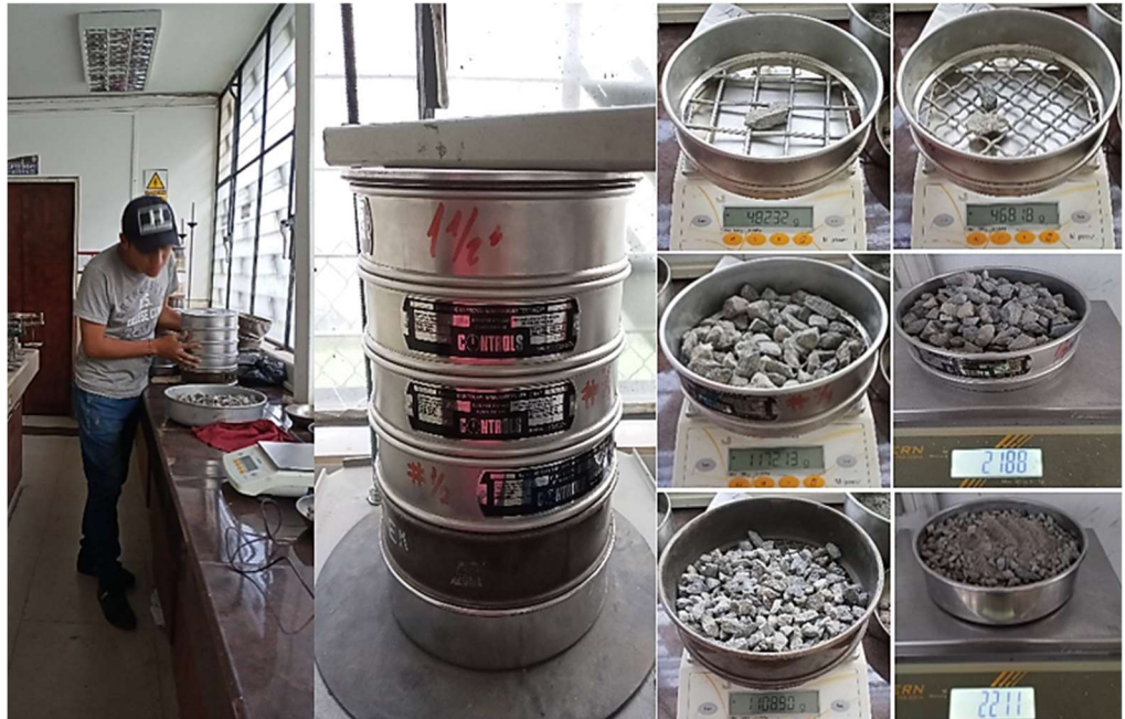
Fotografía 6: Granulometría del agregado grueso (ripio).
