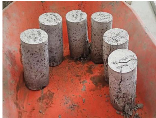
Fotografía 38: Cilindros de hormigón simple ensayados.
