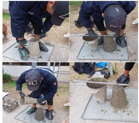
Fotografía 16: Medición del asentamiento del hormigón con fibras de caucho al 5%, con el Cono de Abrams (vertido de hormigón, levantamiento de molde, medición y registro del asentamiento).
