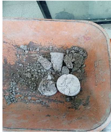
Fotografía 41: Cilindros de hormigón con fibras de caucho al 5 y 10% ensayados.
