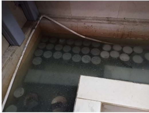
Fotografía 33: Curado de cilindros de hormigón.
