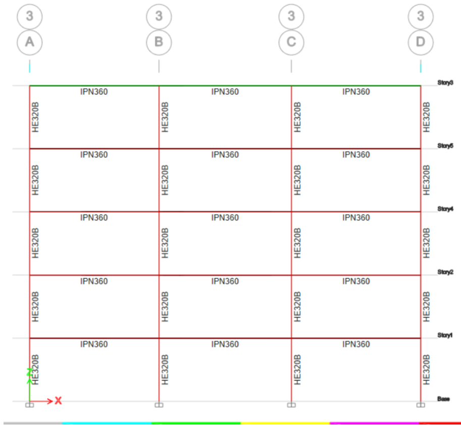
Figura 45. Análisis de elementos demanda vs capacidad, vista en elevación.
