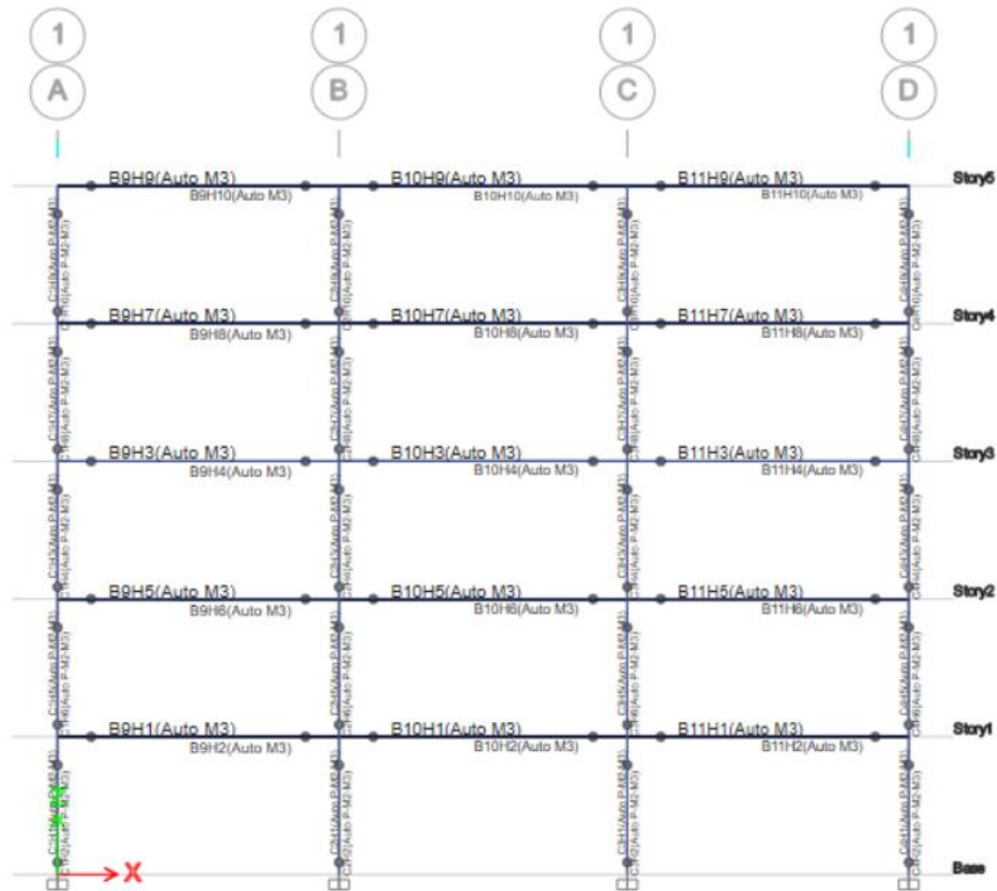
Figura 60. Vista en elevación de rótulas plásticas asignadas
