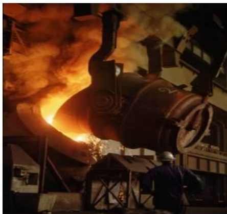
Fig. 2.48 Vaciado del Acero y colado
