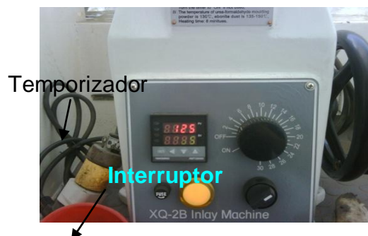
Fig. 6.83. Temporizador para calentamiento.
