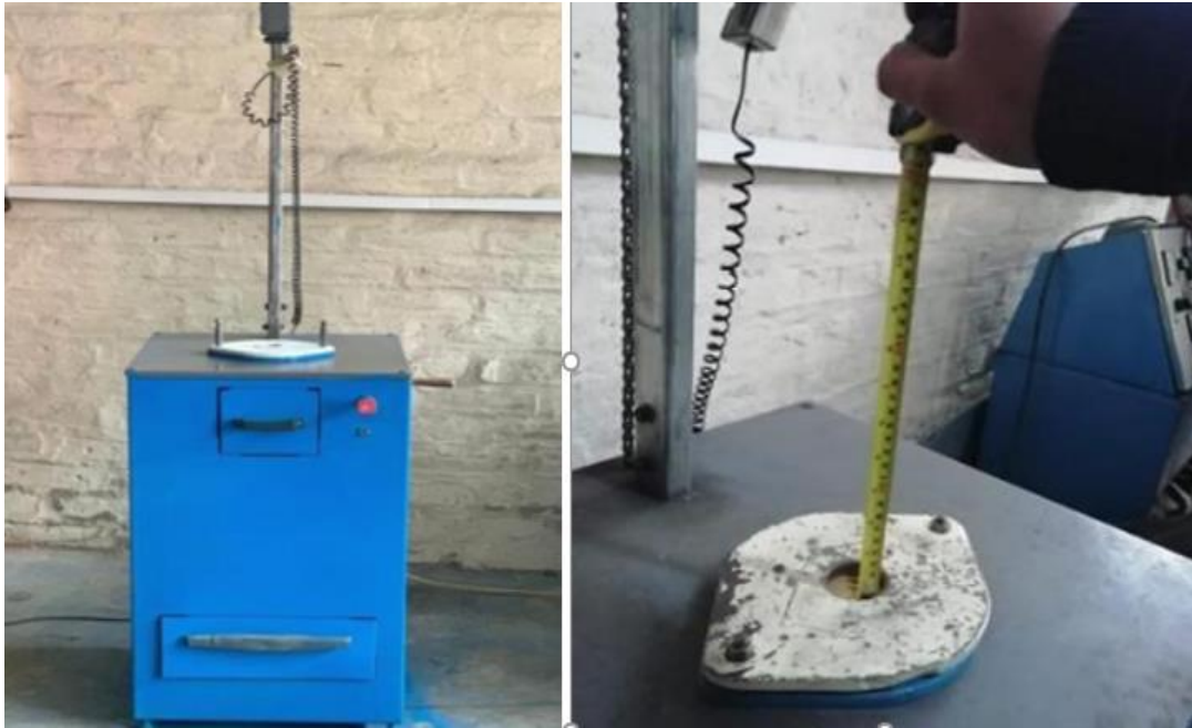
Figura 2.11 Ensayo de impacto bajo la norma ASTM D5628-18.
