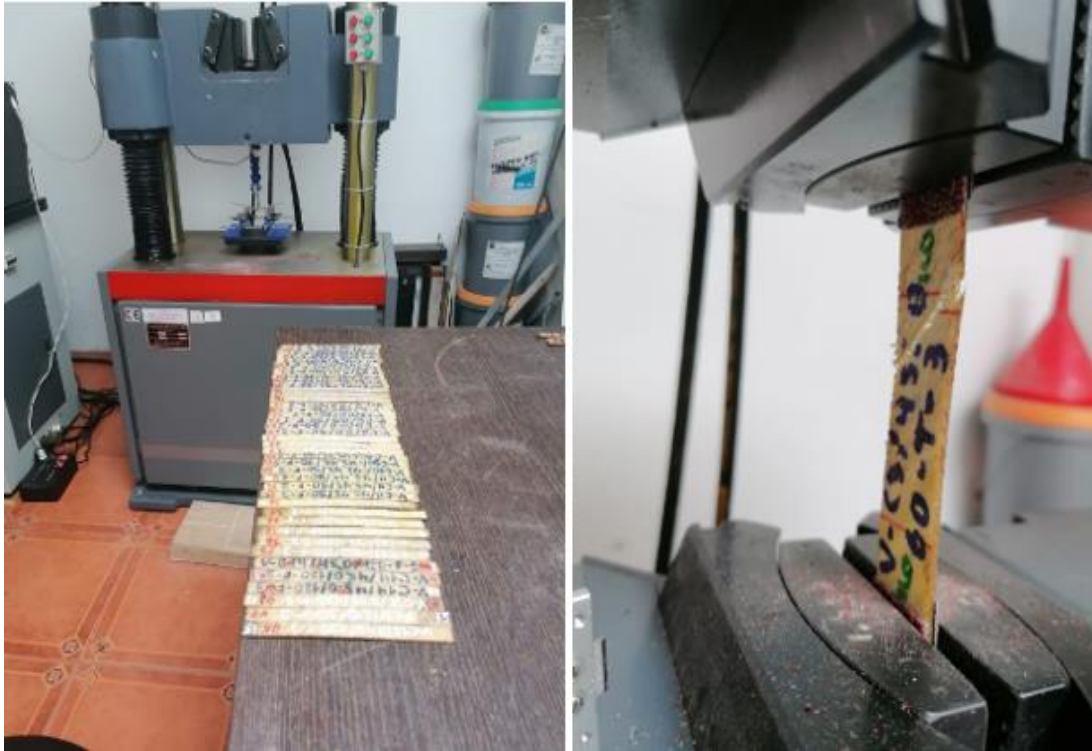
Figura 2.9 Ensayo de Tracción bajo la norma D3039/D3039-17.
