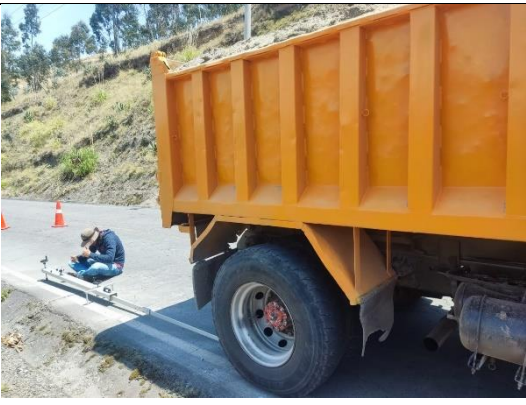
Fotografía 12.- Grabación del dial utilizado para la estimación de las deflexiones
