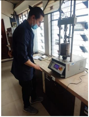
Fotografía 8.- Utilizando la maquina multi-speed mientras se realiza el ensayo CBR
