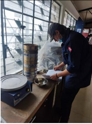
Fotografía 7.- Realizando el ensayo de granulometría para la muestra correspondiente
