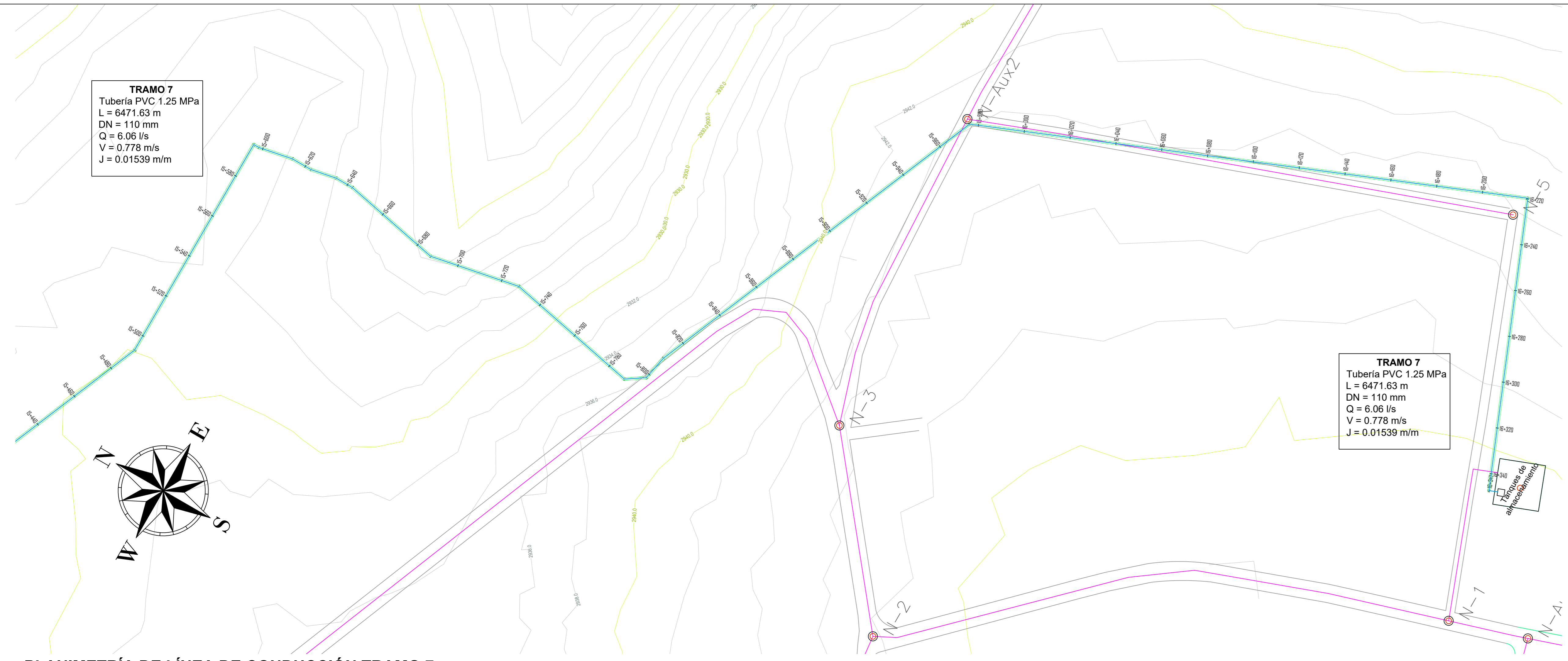
PLANIMETRÍA DE LÍNEA DE CONDUCCIÓN TRAMO 7 Escala: 1:1000
