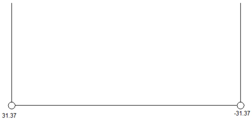
Figura 26: Momentos finales que actúan en los nudos del tanque séptico Fuente: Franklin Álvarez Falcón
