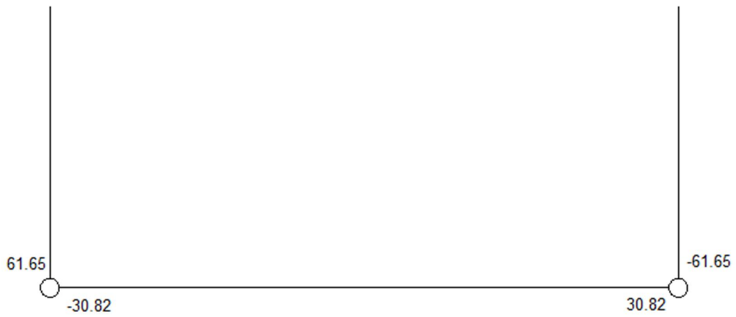
Figura 25: Momentos que actúan en el tanque séptico Fuente: Franklin Álvarez Falcón
