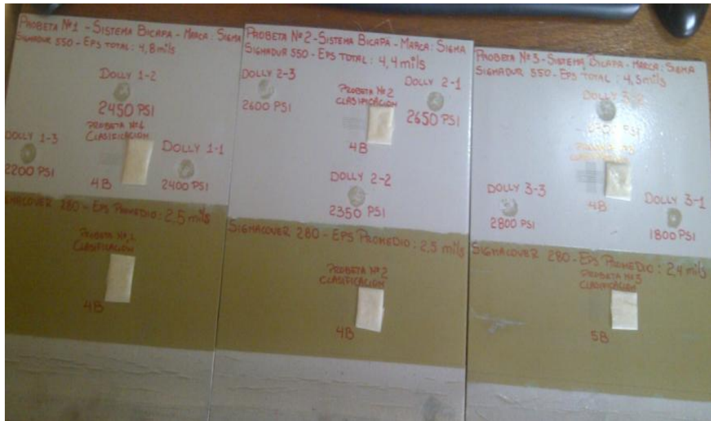
Figura 4.9 Probetas del sistema bicapa después de haber realizado los respectivos ensayos
