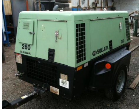
Figura 6.2 Compresor portátil de tornillo.
