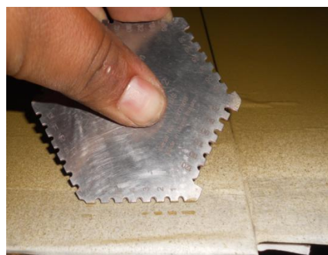
Figura 4.5 y 4.6 Medición de espesor de película húmeda del Sigmacover 280 – ASTM D4414.
