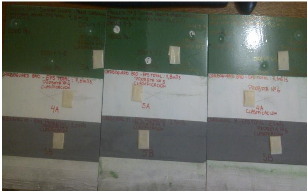
Figura 4.16 Probetas del sistema tricapa después de haber realizado los respectivos ensayos
