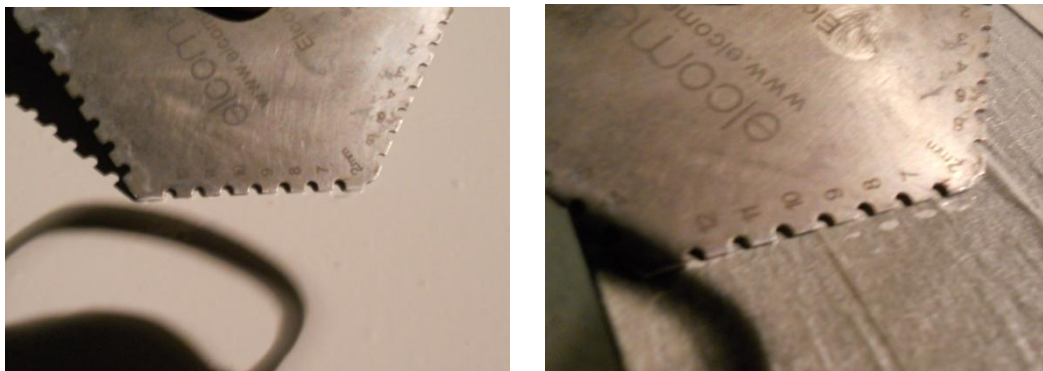
Figura 4.12 y 4.13 Medición de espesor de película húmeda del Carboguard 890 – ASTM D4414.
