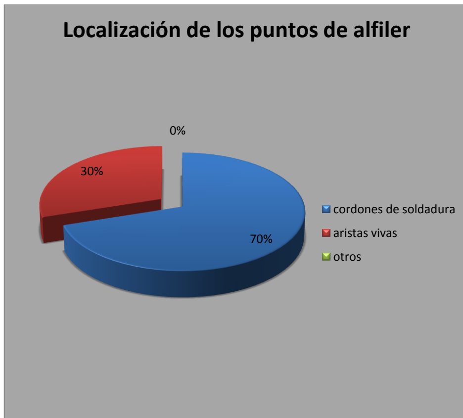
Gráfico 4.7 Grafica de localización de puntos de alfiler del nuevo proceso.
