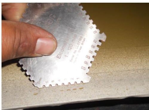
Figura 4.5 y 4.6 Medición de espesor de película húmeda del Sigmacover 280 – ASTM D4414.
