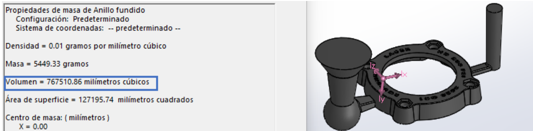
Figura 29. Pieza fundida correspondiente a la brida [Autor].
