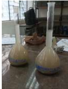
Fig. 91 Ensayo de densidad aparente del agregado fino
