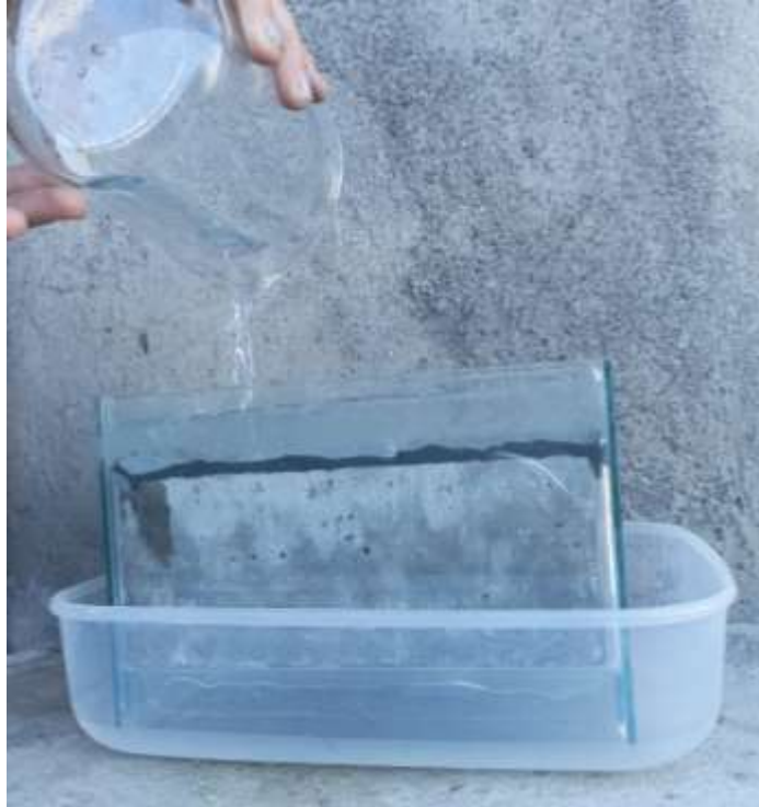
Fig. 75 Aplicación de agua a la muestra de hormigón convencional Autora: Carla Reinoso
