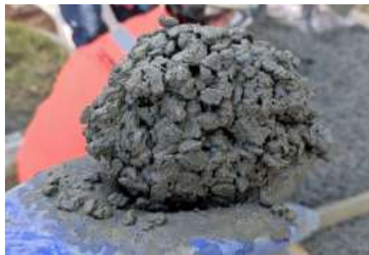
Fig. 3 Consistencia aceptable del hormigón permeable. Fuente: Recomendaciones sobre Pavimentos de hormigón permeable [2]
