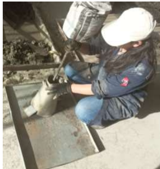
Fig. 22 Elaboración del ensayo del cono de Abrams Fuente: Carla Reinoso
