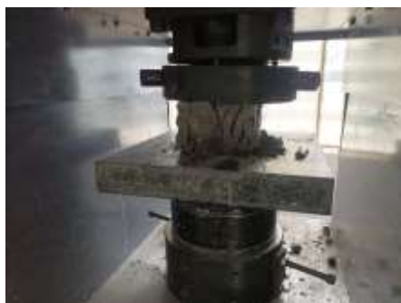
Fig. 95 Probeta de hormigón convencional ensayado a compresión
