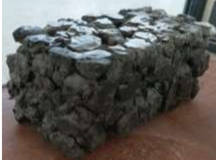
Fig. 77 Adoquín con agregados de 3/4” y sin reforzamiento
