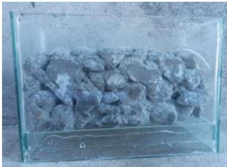
Fig. 72 Molde de Vidrio con una muestra de hormigón permeable Elaborado por: Carla Reinoso
