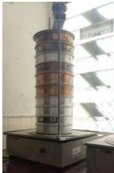
Fig. 34 Tamizadora mecánica Autora: Carla Reinoso
