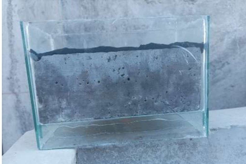
Fig. 73 Molde de vidrio con una muestra de hormigón convencional Elaborado por: Carla Reinoso
