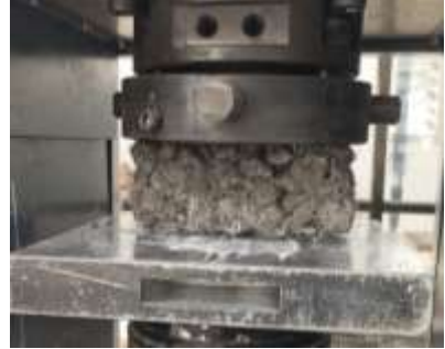
Fig. 78 Adoquín permeable en la máquina de compresión.
