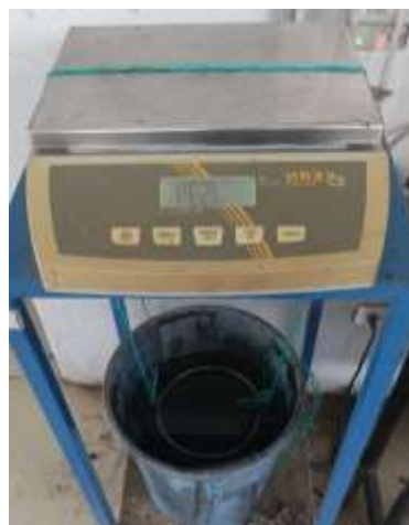
Fig. 13 Ensayo de densidad real del agregado grueso Fuente: Carla Reinoso.
