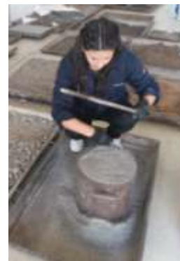
Fig. 90 Ensayo de densidad aparente de agregados finos
