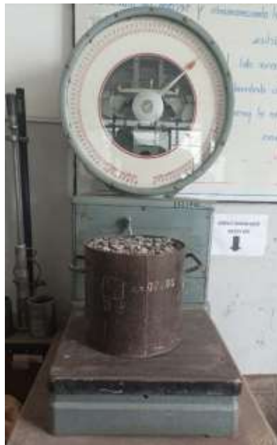
Fig. 16 Ensayo de densidad aparente suelta real del ripio Fuente: Autora, Carla Reinoso
