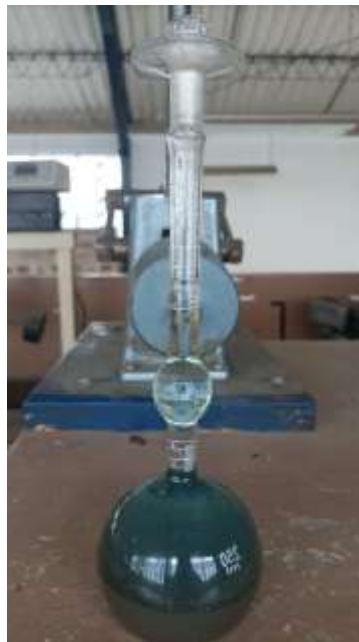
Fig. 19 Ensayo de densidad real del cemento Fuente: Carla Reinoso
