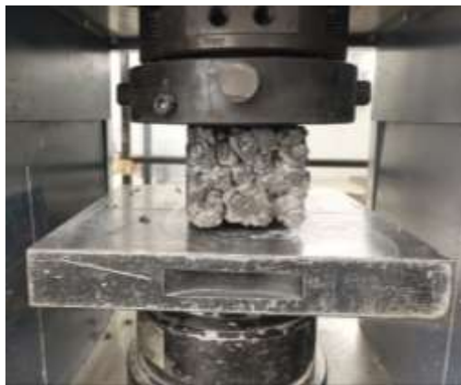
Fig. 43 Colocación de los adoquines en la máquina de compresión Fuente: Carla Reinoso
