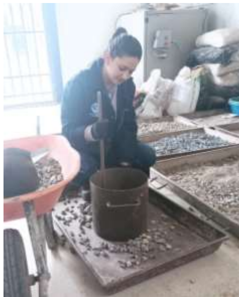
Fig. 17 Densidad aparente compactada del ripio Fuente: Carla Reinoso
