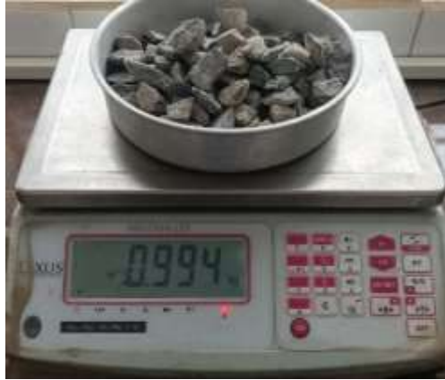
Fig. 18 Peso de la muestra de agregado grueso seco para el ensayo de contenido de humedad Fuente: Carla Reinoso
