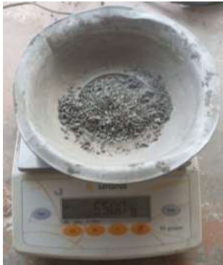
Fig. 14 Lectura de la muestra seca para la capacidad de absorción del agregado fino Fuente: Carla Reinoso
