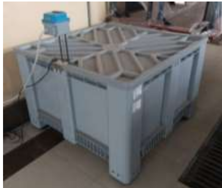
Fig. 79 Cámara de curado con temperatura adaptable
