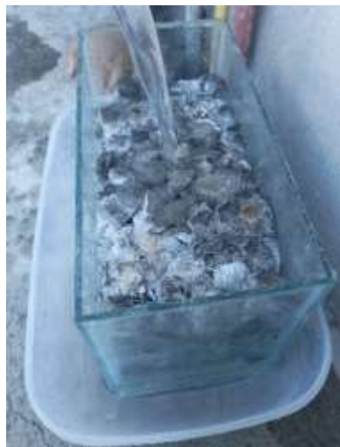
Fig. 76 Aplicación constante de agua en un adoquín permeable Autora: Carla Reinoso
