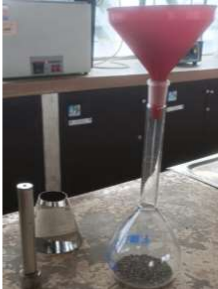
Fig. 12 Ensayo de Densidad real de la arena Fuente: Carla Reinoso
