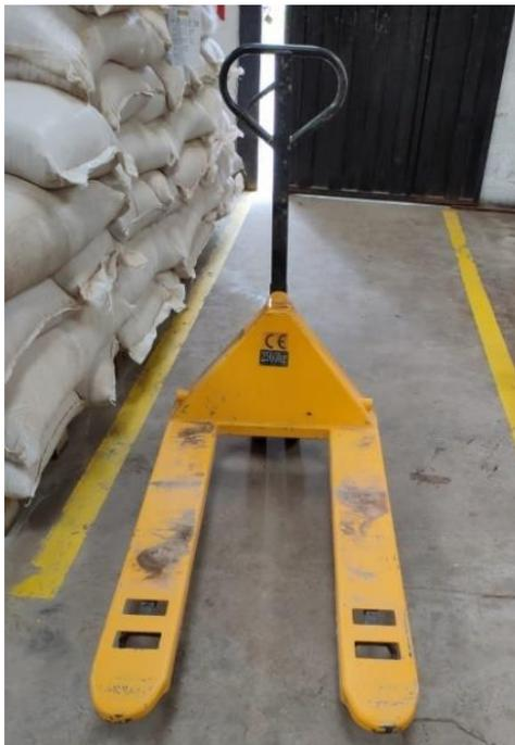
**Figura 19.** Montacargas de materia prima
