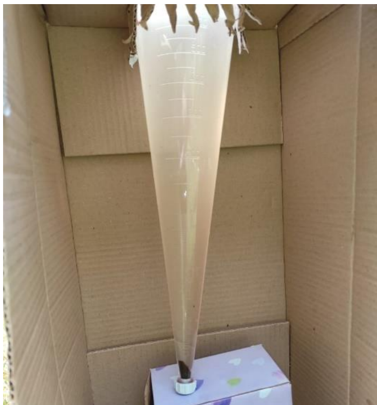
Figura 35. Prueba de sedimentación
