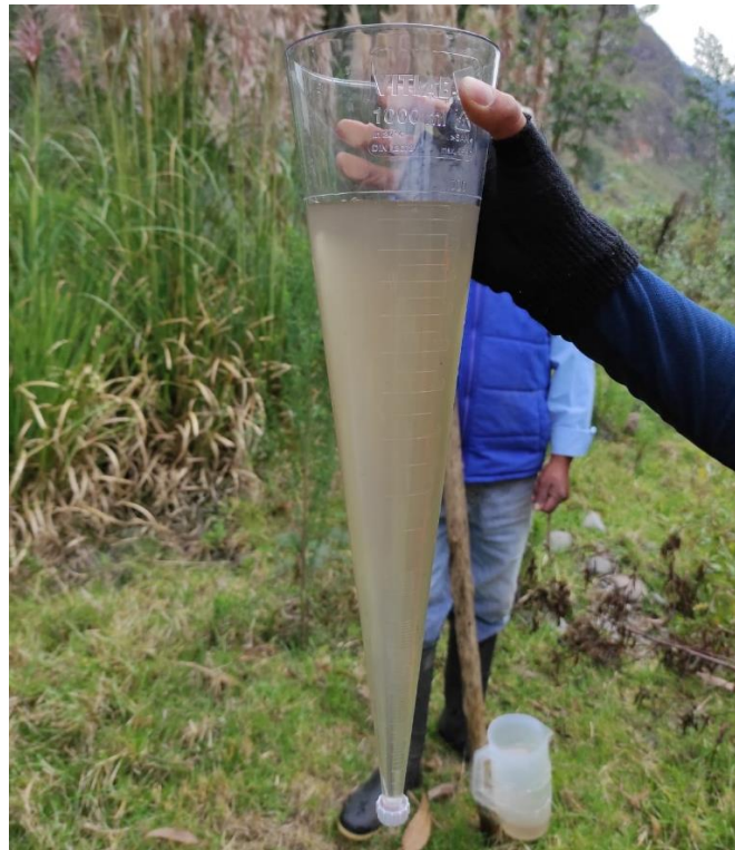
Fotografía N°16. Comprobación de captación de 1000ml para la prueba de sedimentación.
