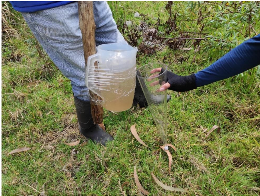
Fotografía N°16. Comprobación de captación de 1000ml para la prueba de sedimentación.
