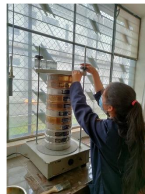
FOTOGRAFÍA 6: Granulometría del agregado restante.
