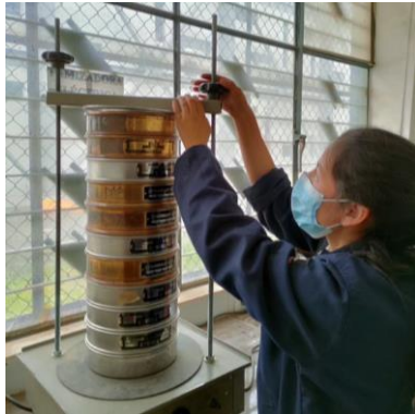
FOTOGRAFÍA 1: Ensayo de granulometría del suelo.
