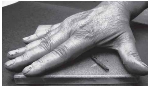
Figura 9.- Prueba de límite plástico
