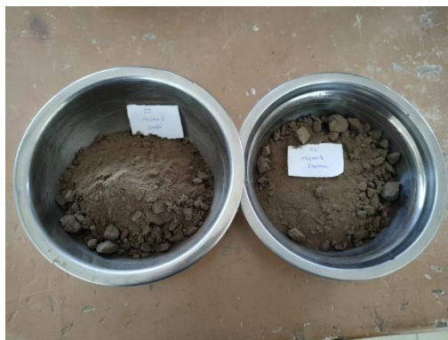
FOTOGRAFÍA 5: Muestras de agregado del asfalto para granulometría.
