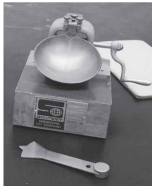
Figura 8.- Dispositivo de Límite líquido y herramienta de ranurado
