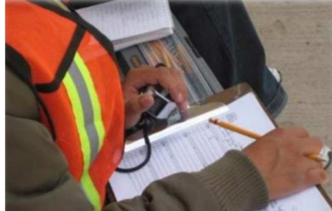
Figura 5. Conteo manual utilizando hoja de conteo
