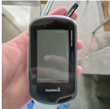
FOTOGRAFÍA 1: GPS para levantamiento marca GARMIN modelo Oregon 650.
