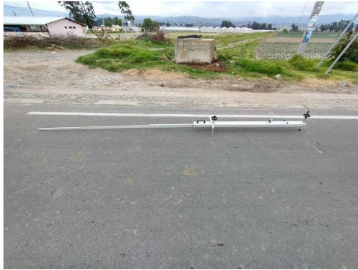
FOTOGRAFÍA 1: Viga Benkelman armada.
