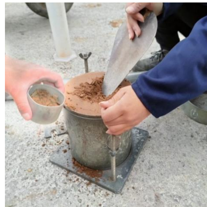
FOTOGRAFÍA 6: Extracción de muestras de Proctor modificado.
