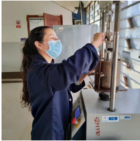
FOTOGRAFÍA 7: Ensayo de CBR en máquina para medición de esfuerzos
