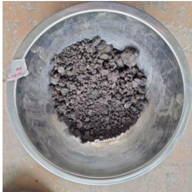
FOTOGRAFÍA 1: Disgregación de las muestras de asfalto
