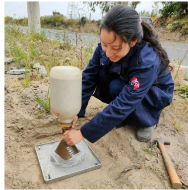
FOTOGRAFÍA 4: Ensayo de densidad de campo (método de cono y arena)
