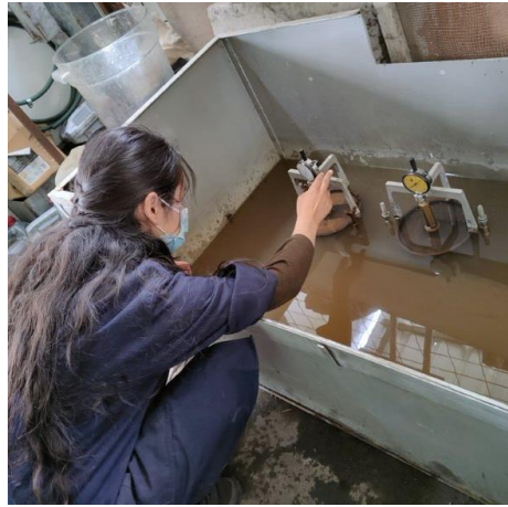
FOTOGRAFÍA 8: Ensayo de CBR sumergido
