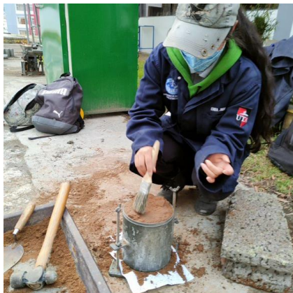
FOTOGRAFÍA 5: Preparación de diferentes capas para próctor modificado
