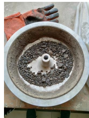
FOTOGRAFÍA 4: Obtención de muestra de asfalto después del ensayo
