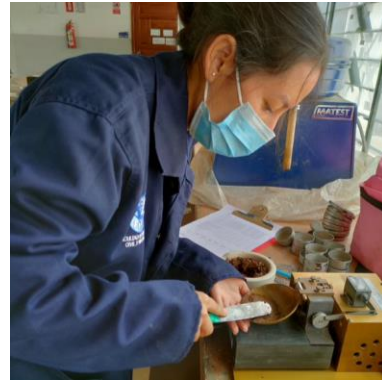
FOTOGRAFÍA 2: Ensayo Límite Líquido con la Copa Casagrande
