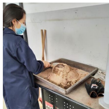
FOTOGRAFÍA 4: Preparación de muestra para ensayo Proctor modificado
