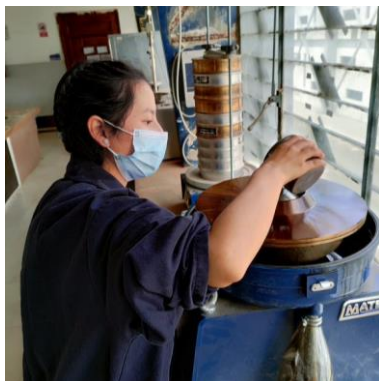
FOTOGRAFÍA 3: Adición de gasolina a la muestra de asfalto
