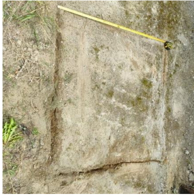
FOTOGRAFÍA 1: Delimitación de área para la calicata (1m x 1m)
