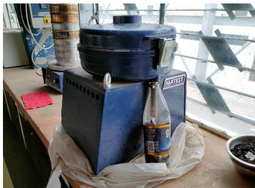
Figura 29. Equipo para extracción de asfalto de una mezcla asfáltica
