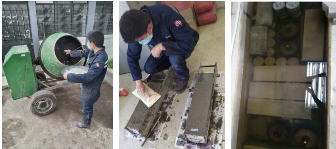
Figura 23. (a) Adición de fibras al hormigón, (b) Elaboración de las probetas (c) Curado de las vigas
