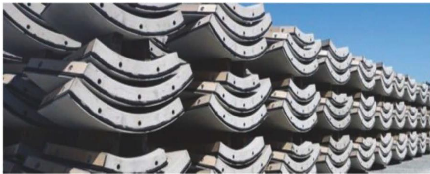
Figura 10. Revestimientos de túneles prefabricados
