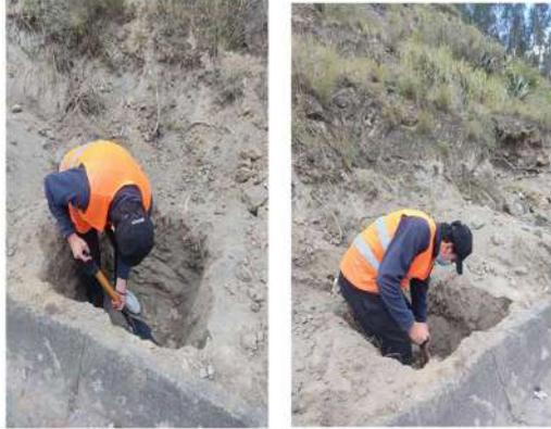
**Descripción:** Extracción de muestras de suelo in situ de suelo para realizar los posteriores ensayos en el laboratorio de la facultad.
