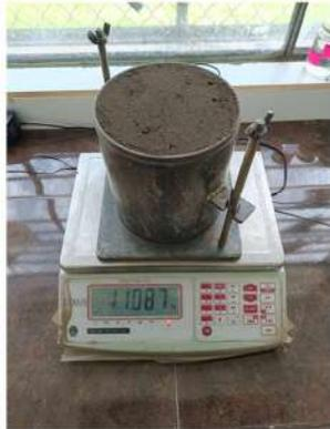
**Descripción:** Peso de muestra después de realizar el ensayo de proctor.
