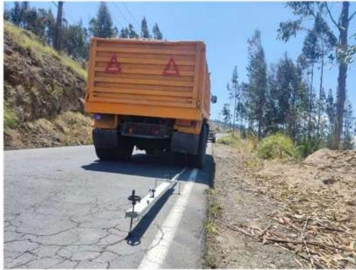
**Descripción:** Montaje de los equipos que intervienen en el ensayo de la viga Benkelman
