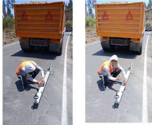
**Descripción:** Calibración del dial de la viga Benkelman y realización del ensayo.
