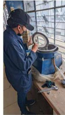
**Descripción:** Extracción de contenido de asfalto utilizando la máquina de centrifugado en los laboratorios de la facultad.
