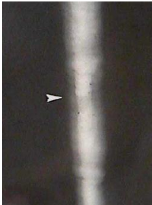
Gráfico 6.26. Placa radiográfica de Porosidades.
