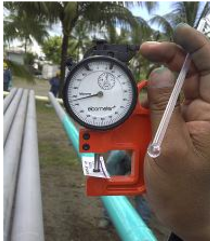
Foto 6.19. Medición de cintas con micrómetro.
