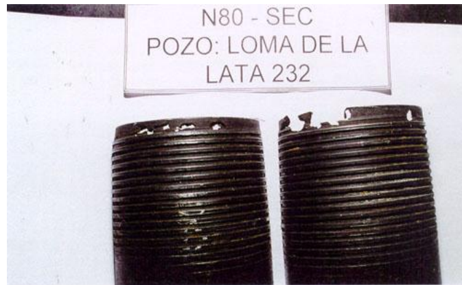
Gráfico 2.5. Caso típico de corrosión por CO 2 .
