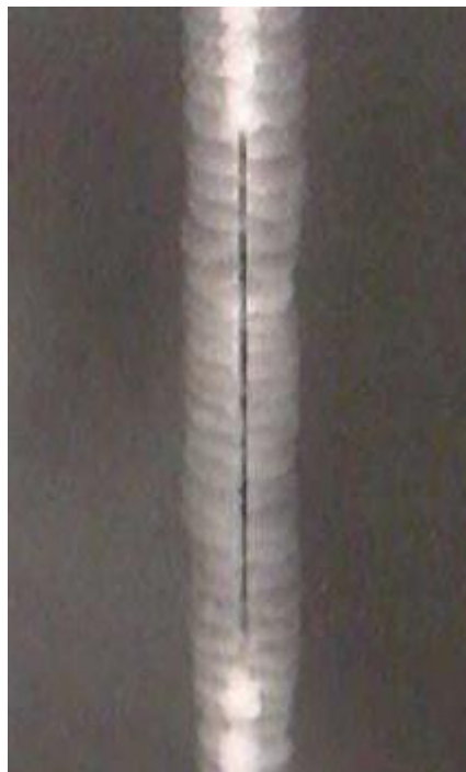
Gráfico 6.16. Placa radiográfica de una falta de penetración.
