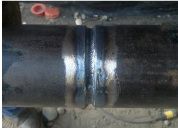
Foto 6.4. Pase de raíz proceso GTAW.
