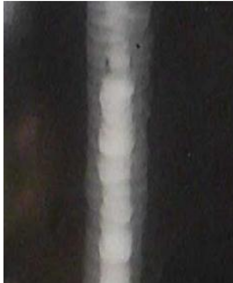
Gráfico 6.12. Placa radiográfica de un exceso de penetración.
