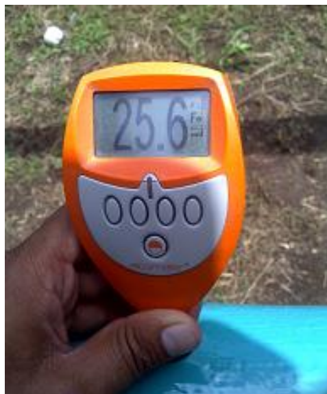
Foto 6.23. Medición de espesores de película seca.
