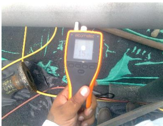
Foto 6.14. Medición de condiciones climáticas.
