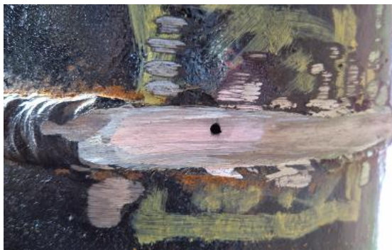
Foto 6.12. Porosidad en junta soldada.
