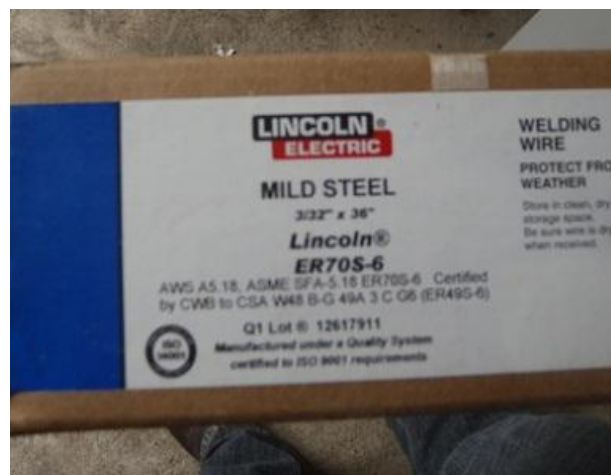
Foto 6.1. Inspección de aporte ER70 S-6.
