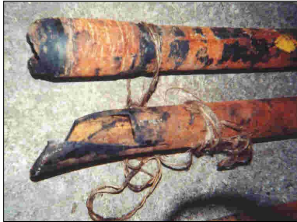
Gráfico 2.4. Caso típico de corrosión por H 2 S.
