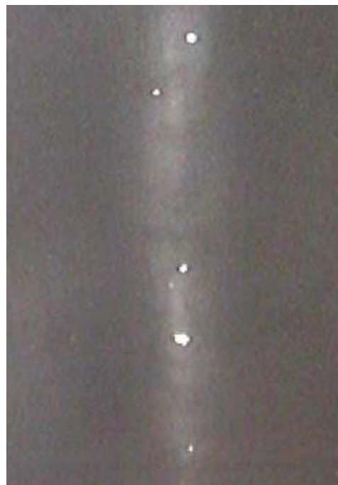
Gráfico 6.10. Placa radiográfica de una inclusión de tungsteno.
