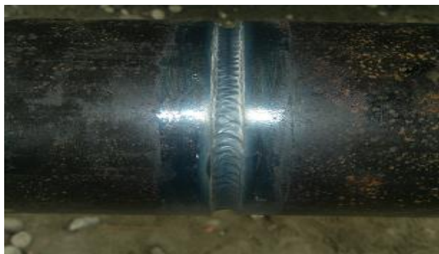
Foto 6.5. Pase en caliente proceso GTAW.
