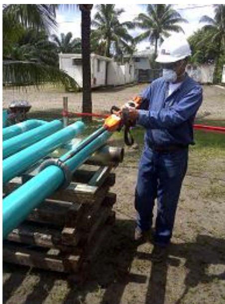
Foto 6.24. Inspección de discontinuidades con “Holliday Detector”.
