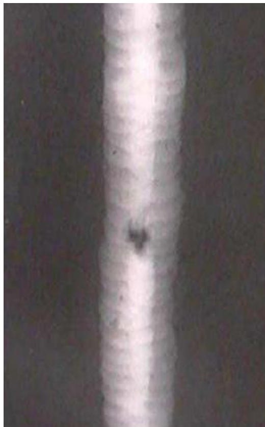
Gráfico 6.24. Placa radiográfica de un quemón.
