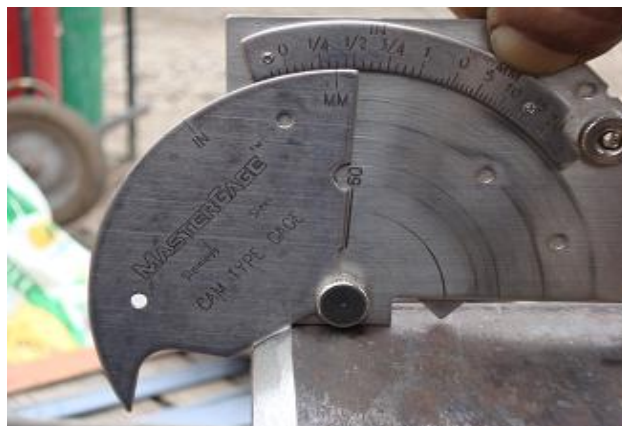
Foto 6.3. Verificación de ángulo de bisel.
