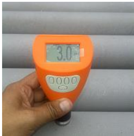
Foto 6.17. Lectura del perfil de anclaje con medidor digital.
