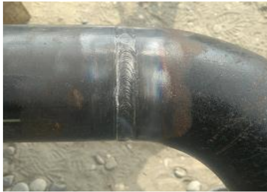
Foto 6.6. Pase de relleno proceso SMAW.
