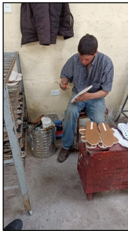
Figura 21. Proceso de aplicación de pega
