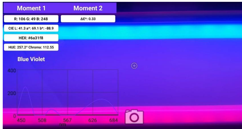
Figura 45: Espectro de las lámparas leds rojo y azul en nm
