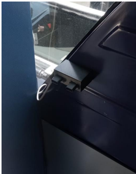
Figura 82 Contador de personas (sistema infrarrojo)
