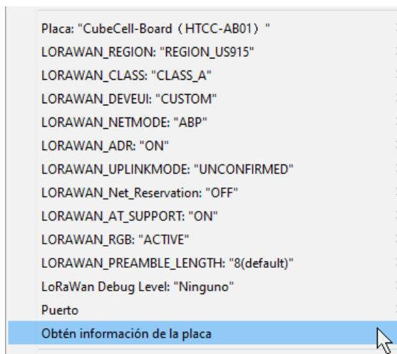
Figura 60 Configuración manual en Arduino para CubeCell
