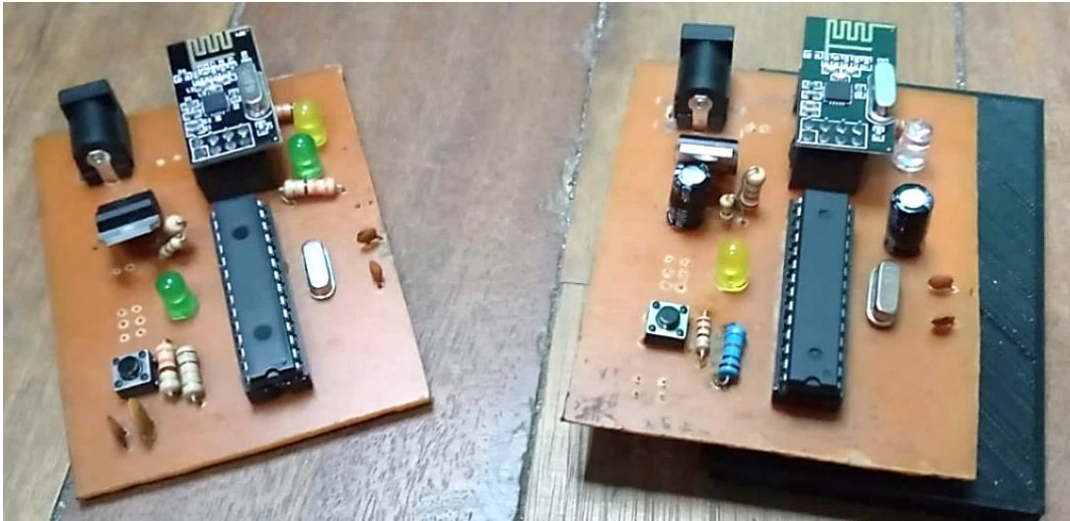
Figura 73 Tx y Rx de RF tanto del autobús como de la parada
