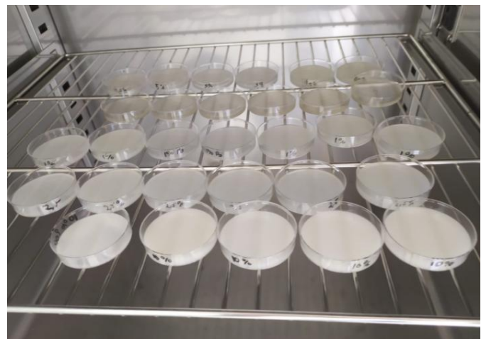
Anexo D-4. Secado de las películas en la incubadora a 50°C por 24 horas.
