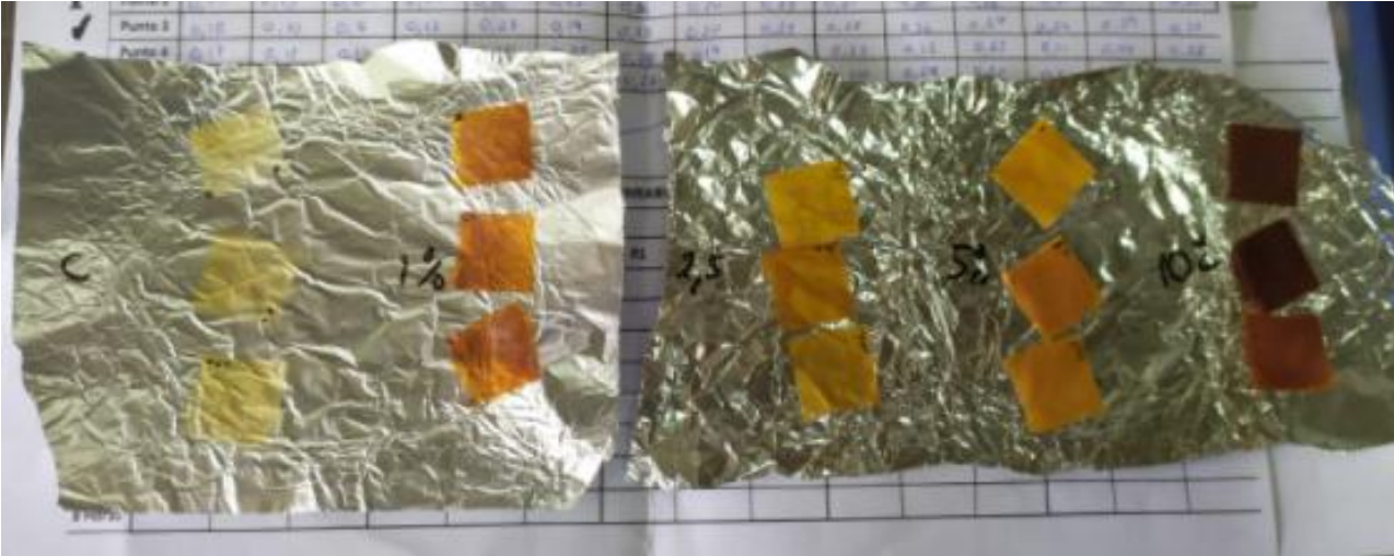
Anexo D-10. Películas (20 * 20mm) pre-tratadas a 110°C por 24 horas.
