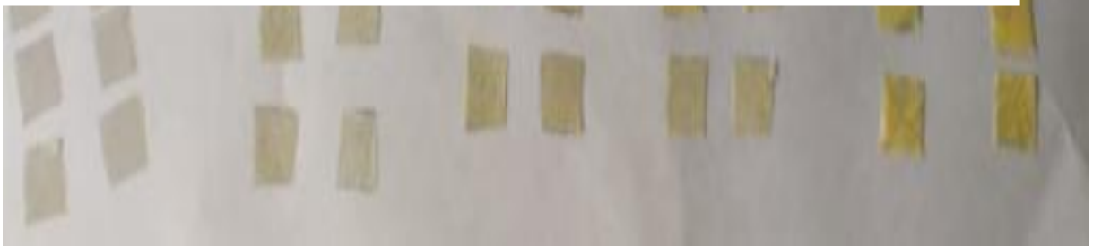
Anexo D-6. Preparación de las muestras (20 * 20 mm) para las pruebas de solubilidad, capacidad de hinchamiento y humedad.
