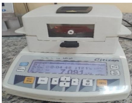
Figura 9. Determinación de Humedad
